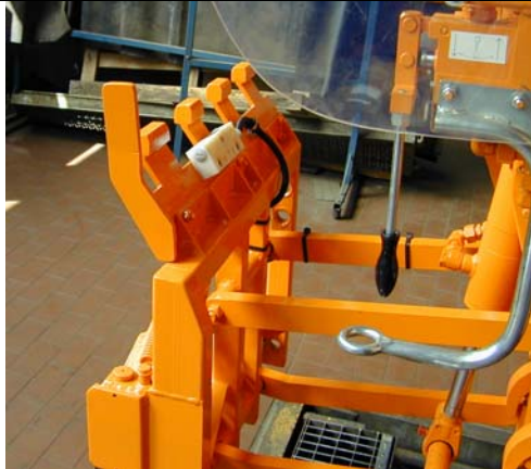
Abb.2: Kammantenne am Lifter eines Heckladers (Bildquelle: www.moba.de )
