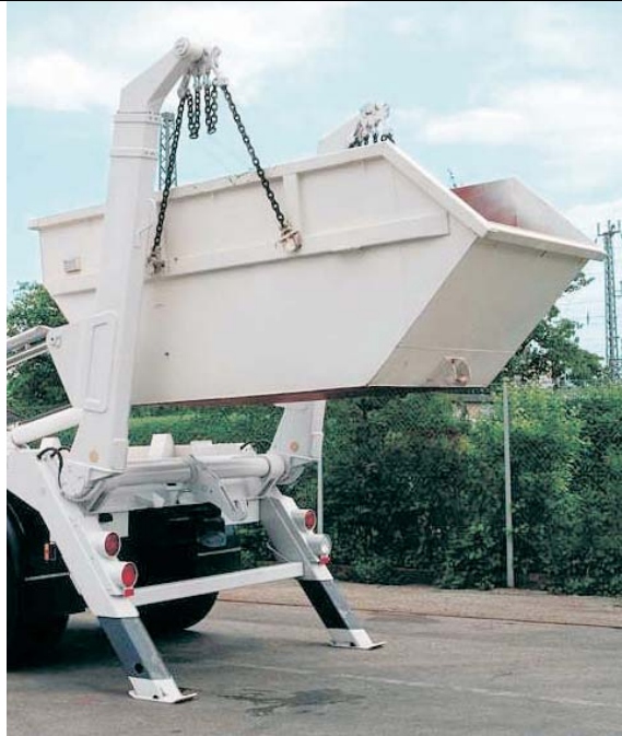
Abb.1: Fahrzeugaufbau und Absetzmulde – Basisvariante beim Absetzvorgang (Bildquelle: www.meiller.com )
