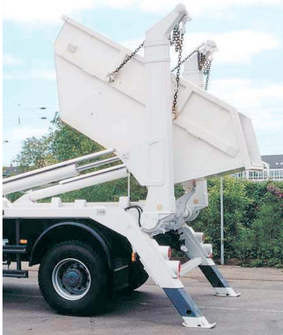
Abb.2: Fahrzeugaufbau und Absetzmulde – Basisvariante beim Abkippvorgang (Bildquelle: www.meiller.com )
