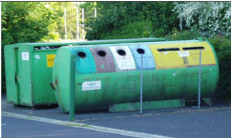
Abb.3: Abrollcontainer mit Einwurföffnungen (Bildquelle: Intecus GmbH)
