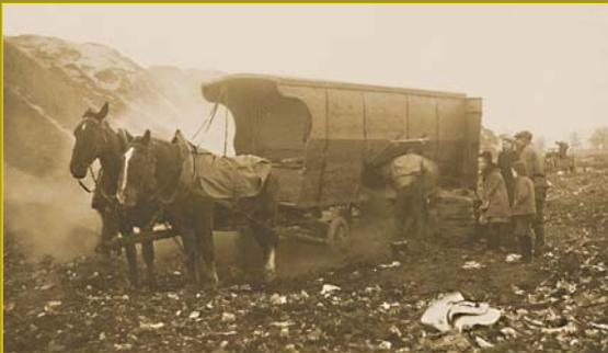
*Entleerung der Müllwagen durch Seitenklappen
