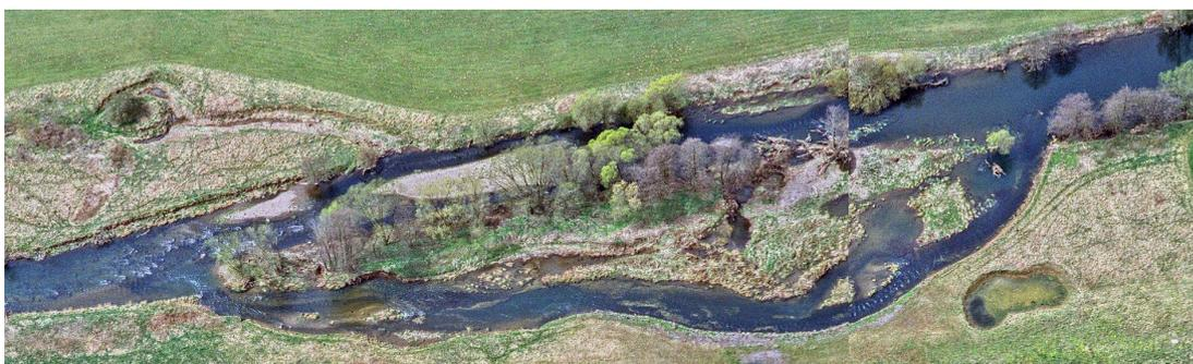
Abb. B.2: Gewässertypgerechte Entwicklung eines Standortes an der oberen Lahn (Hessen): die ursprünglich vorhandenen Furkationen stellen sich wieder ein und bilden durchwanderbare Gewässerarme mit natürlichem Sohlgefälle. Die Gewässerarme sind gegenüber Fischaufstiegsanlagen, die das Gefälle lokal konzentrieren, weniger wartungsintensiv und ökologisch hochwertiger.
