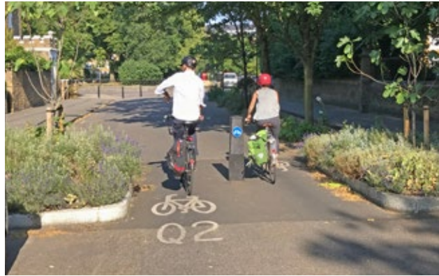
Schwer sichtbarer Poller auf einer Nebenroute in London, in Kombination mit einer gut gestalteten Fahrbahnverengung.
