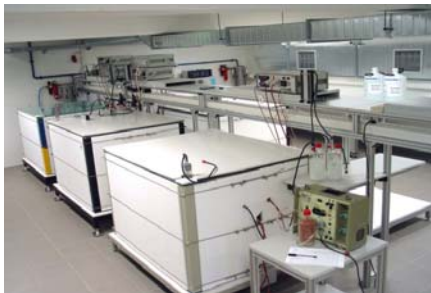
Emissionskammerprüfung gemäß ISO 16000 – 9.
