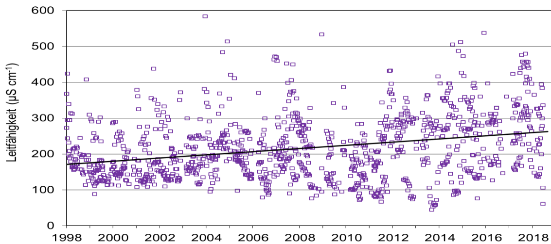
Abb.18b: Leitfähigkeit im Sickerwasser (120 cm)
