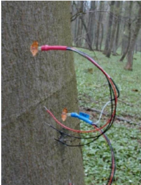
Abb.12: Granier-Sensor: Einbau am Beispiel einer Buche
