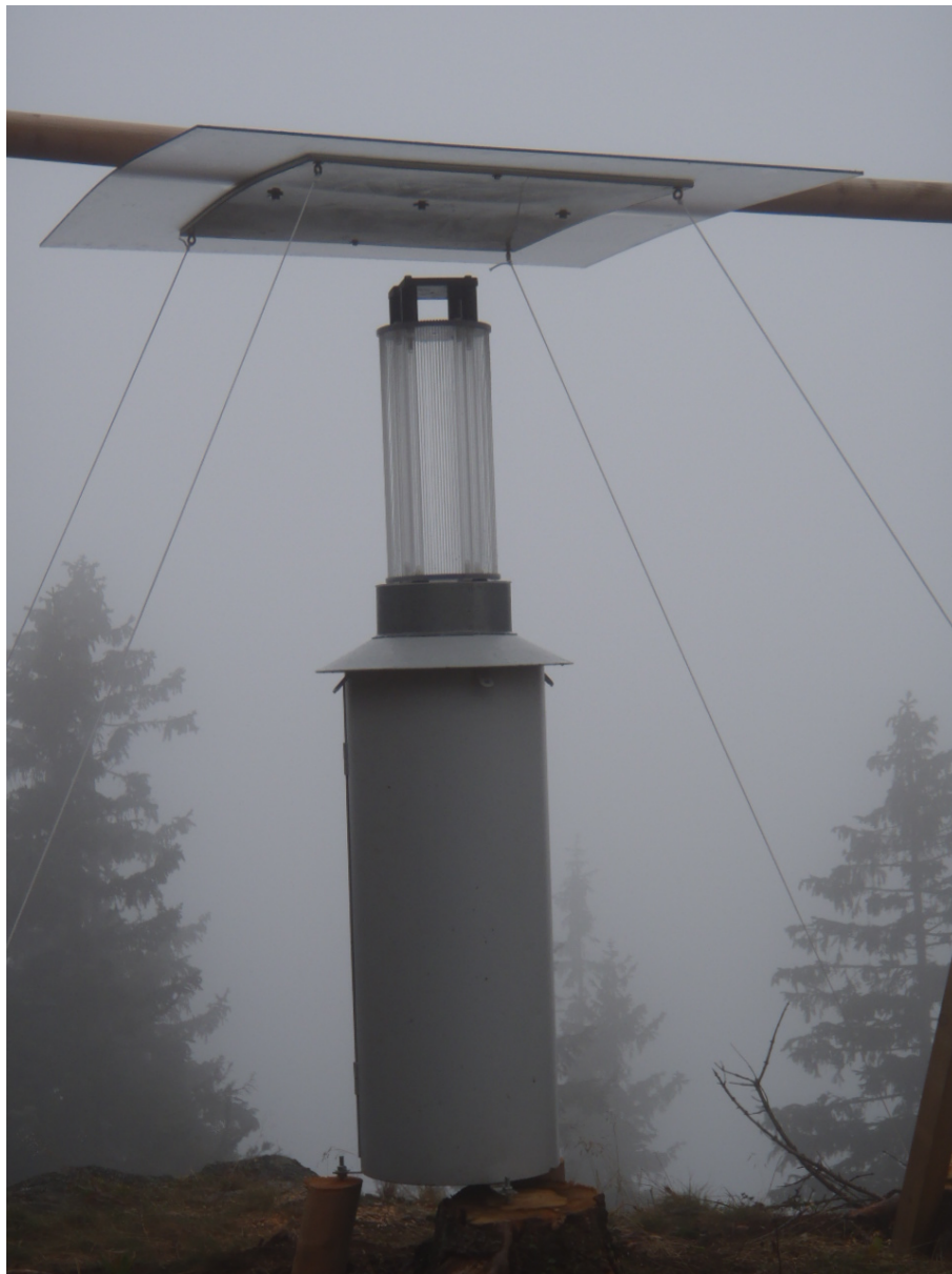
Abb. 4: Nebelfänger mit Schutz gegen fallenden Niederschlag am Großen Falkenstein
