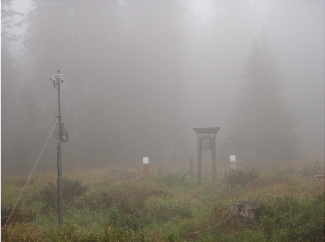
Abb. 1: Bulk-Sammler, wet-only, Monatstotalisator und Distrometer am Großen Falkenstein.
