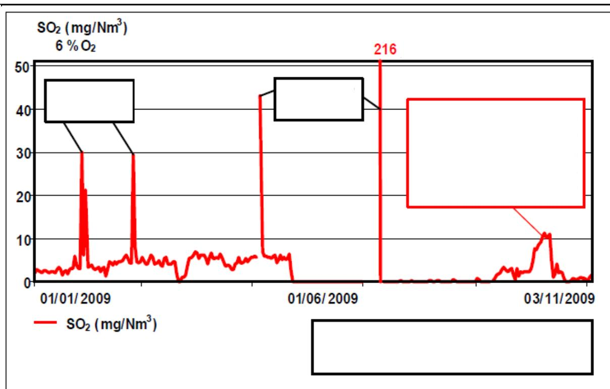
Abbildung 3.51: Kontinuierlich gemessene Tagesmittelwerte für SO<sub>2</sub>-Emissionen von einem Ablaugekessel einer Sulfatzellstofffabrik
