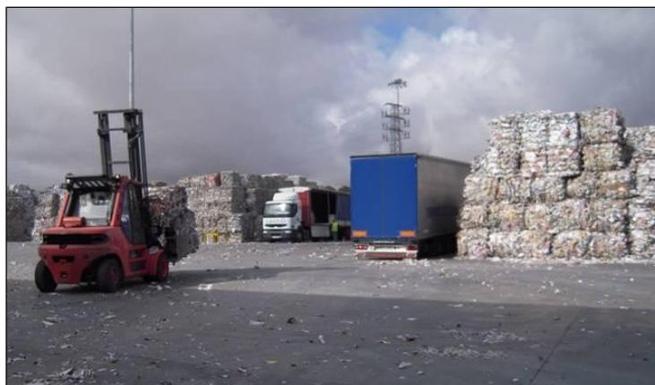
Abbildung 6.30: Lagerung von Altpapier im Freien auf Betondecke
