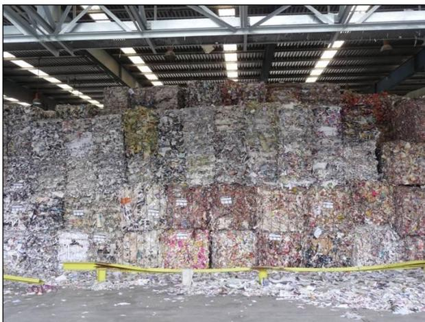
**Abbildung 6.31:** Lagerung von Altpapier in Ballen unter einem Dach
