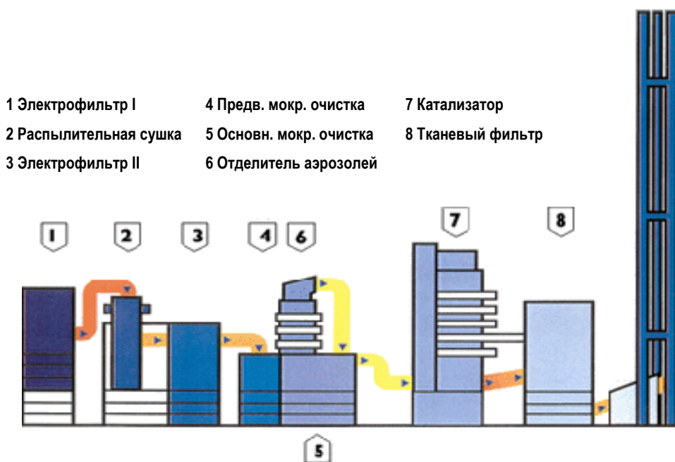
Рис. 11: Схема 8-ступенчатой системы обработки топочных газов
