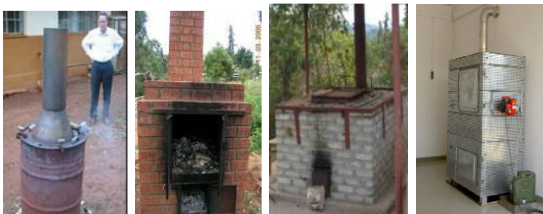
Рис. 14: Сжигательная установка барабанного типа; одноступенчатый сжигатель печного типа; малогабаритный инсинератор Де-Монфорта; современный тип малогабаритного инсинератора
