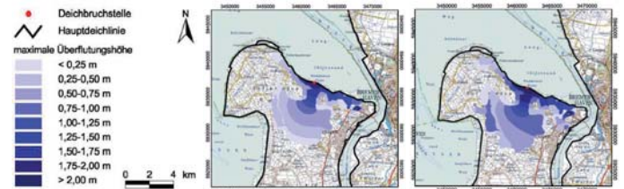
Überflutungssimulation (Mai et al. 2004): Überflutungsausdehnung und -höhen bei einem Deichbruch für die Sturmflut vom 3. Januar 1976 (links) und für das 2050-Klimaszenario (rechts)
