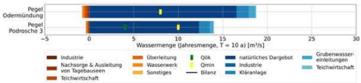
Abbildung 32: Wasserwirtschaftliche Jahresbilanz im Längsschnitt der Lausitzer Neiße bei wasserarmen Verhältnissen für die Phase 6 (Quelle: WBaIMo-Ländermodell LM200320_03)
