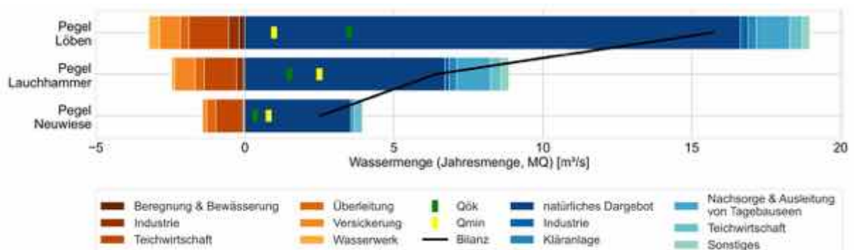
Abbildungung 25: Wasserwirtschaftliche Jahresbilanz im Längsschnitt der Schwarzen Elster bei mittleren Verhältnissen für die Phase 7 (Quelle: WBaIMo-Ländermodell LM200320_03)
