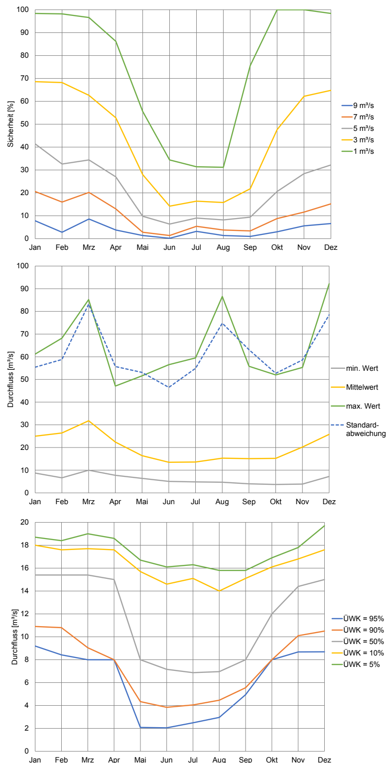
Abbildung 25: Exemplarische Ergebnisse einer Registrierung Typ 1 – Sicherheiten für vordefinierte Durchflüsse eines Gewässerquerschnitts (oben), einer Registrierung Typ 3 - Mittelwerte, Standardabweichungen, Minima und Maxima von Durchflüssen eines Gewässerquerschnitts (mittig) und einer Registrierung Typ 5 - Durchflüsse der Perzentile (=Überschreitungswahrscheinlichkeit - ÜWK) einer Periode eines Gewässerquerschnitts (unten).
