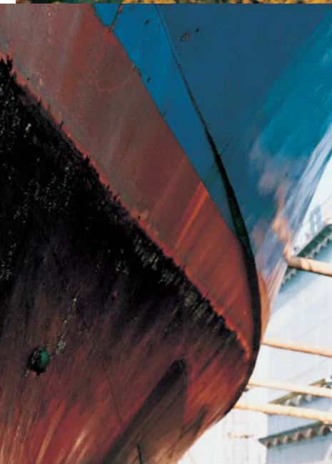
Das hochgiftige TBT konnte den Bewuchs auf diesem Patrouillenboot der Wasserschutzpolizei Niedersachsens nicht aufhalten (links). Auf einer lediglich mit Silikon beschichteten Testfläche (oben) hingegen vermochten sich nur einige kleine Seepocken zu halten, größere wurden abgespült (braun erscheinende Flecken von Mikroalgen, gelb die unbesiedelte Oberfläche der Beschichtung).
