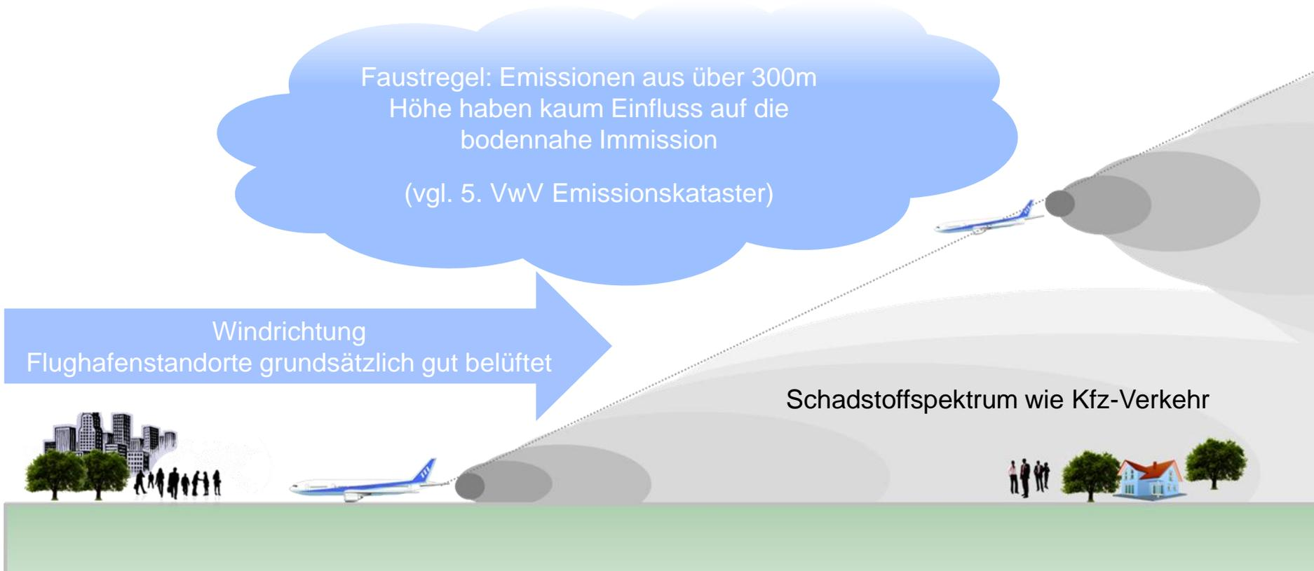
Schematische Darstellung zum Höheneinfluss: Dunkle kleine Flächen entsprechen hoher Konzentration, helle große Flächen symbolisieren Verdünnung und Ausdehnung der Abgasfahne.
