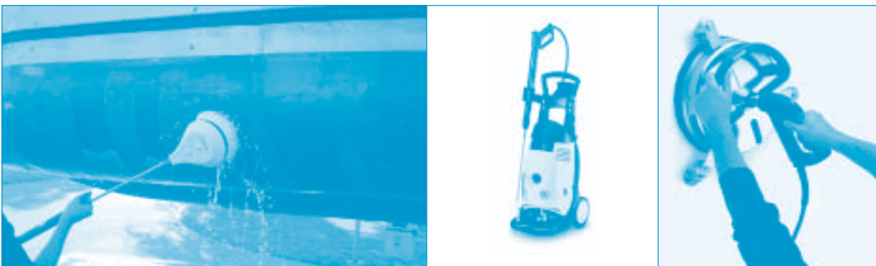
Untersuchung von Reinigungsverfahren mit unterschiedlichen Reinigungswerkzeugen. Versuchsparameter: Borstenmaterial Rosshaar, PA6, PBT, PP, Borstenlänge 45-125 mm, Borstendurchmesser 0,3-2,0 mm, Druck 150-230 bar, Wassermenge 8-16 l/min.
