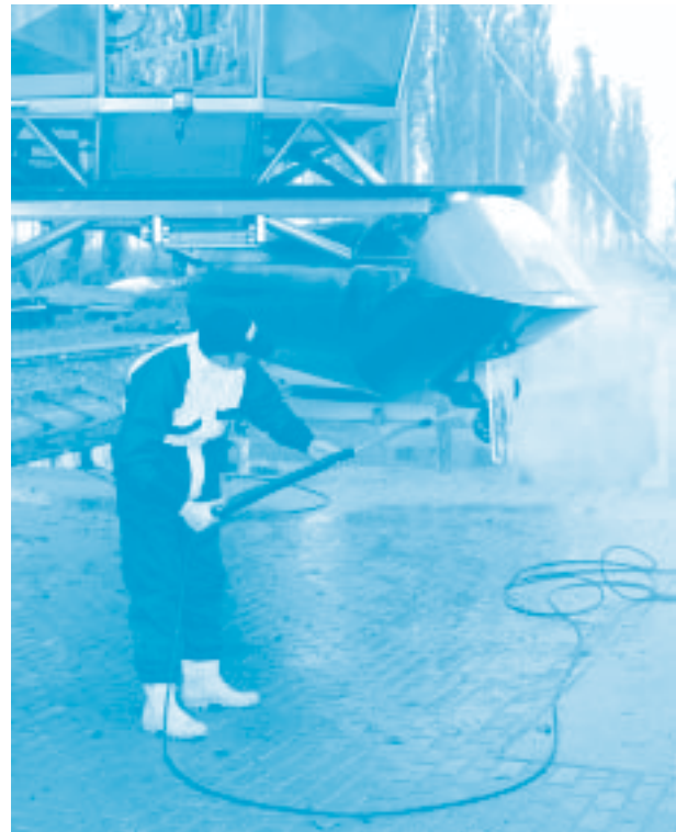
Reinigung des Unterwasserschiffs an Land mit Hilfe von Hochdruckreiniger.
