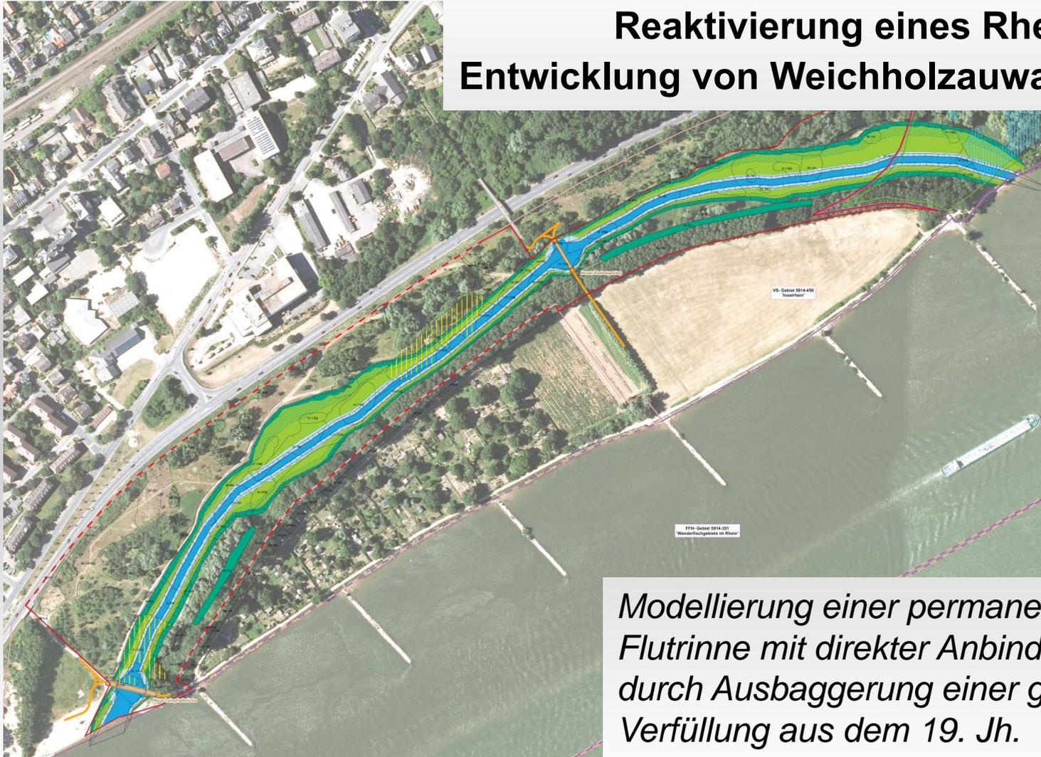
*Modellierung einer permanent durchströmten Flutrinne mit direkter Anbindung an den Rhein durch Ausbaggerung einer großflächigen Verfüllung aus dem 19. Jh.*
