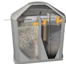
Šematski prikaz BIOROTORA (TEHNBIX d.o.o.)
