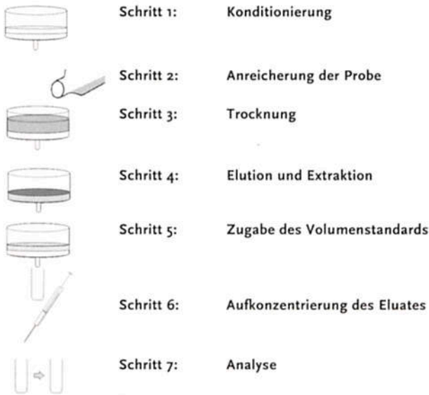
Bild 2: Schematische Darstellung des SPE-Probenbereitungsverfahrens mittels SPE-Disk
