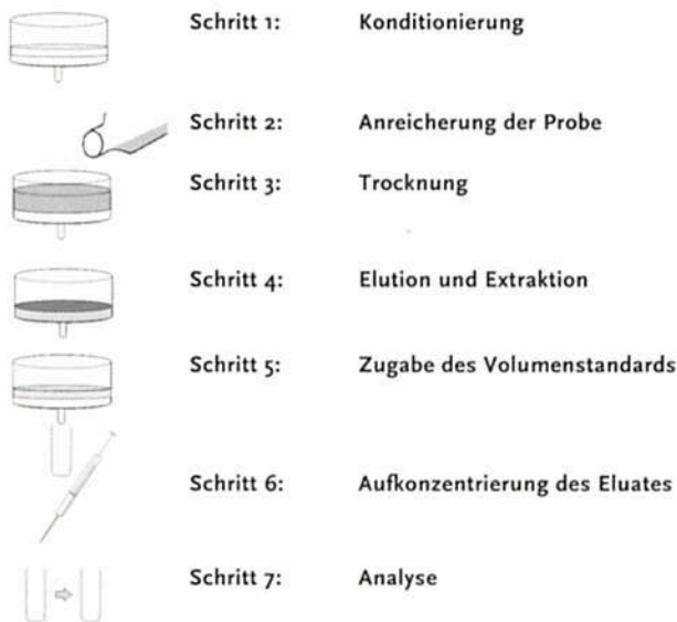
Bild 2: Schematische Darstellung des SPE-Probenbereitungsverfahrens mittels SPE-Disk
