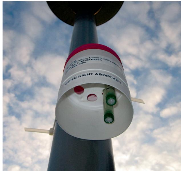
Passivsammler: Ein Passivsammler ist ein kleines, ohne Energie betriebenes Messgerät, in dem mehrere Prüfröhrchen die Schadstoffe aus der Luft aufnehmen. Die Röhrchen werden regelmäßig eingesammelt und der Inhalt im Labor ausgewertet.
