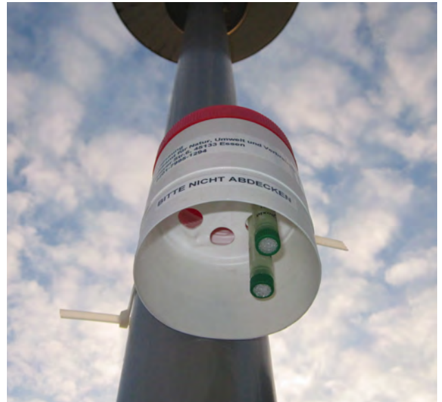
Passivsammler: Ein Passivsammler ist ein kleines, ohne Energie betriebenes Messgerät, in dem mehrere Prüfröhrchen die Schadstoffe aus der Luft aufnehmen. Die Röhrchen werden regelmäßig eingesammelt und der Inhalt im Labor ausgewertet.
