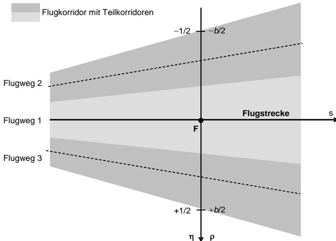
Abbildung 5: Beschreibung eines Flugkorridors durch Teilkorridore und Flugwege (beispielhaft für eine Zerlegung in drei Teilkorridore)
