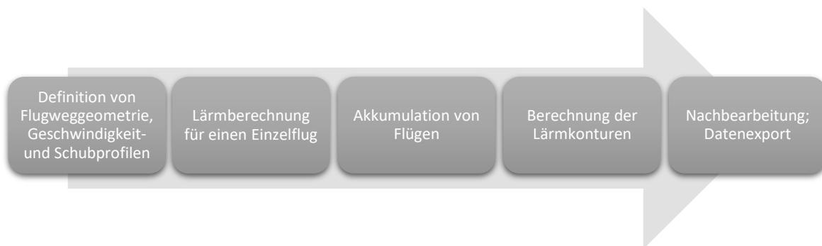
Abbildung 1: Der Prozess der Lärmkonturengenerierung
