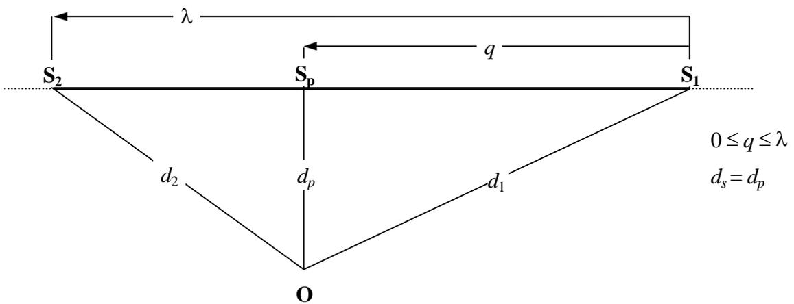
Abbildung 11: Flugbahnsegmentgeometrie bei neben dem Segment befindlichem Immissionsort
