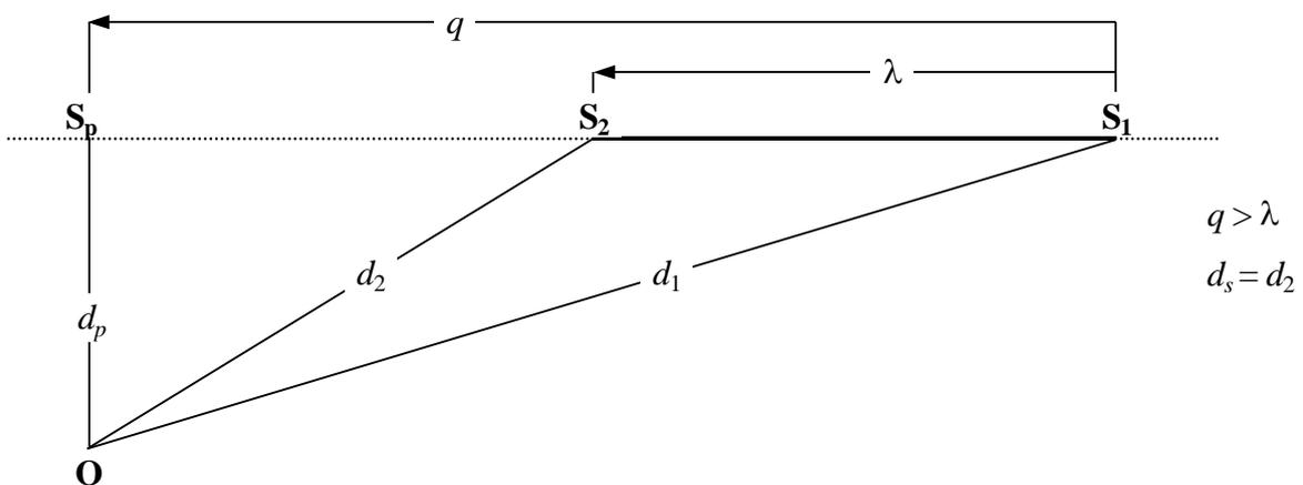
Abbildung 12: Flugbahnsegmentgeometrie bei vor dem Segment befindlichem Immissionsort
