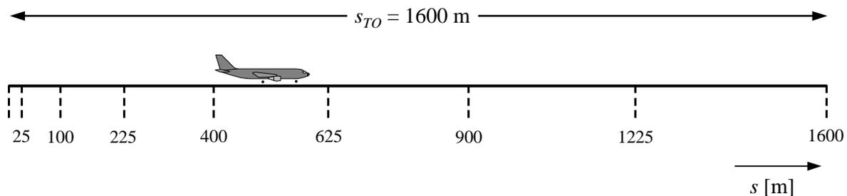
Abbildung 7: Teilsegmentierung einer Startrollstrecke; Beispiel für acht Teilsegmente
