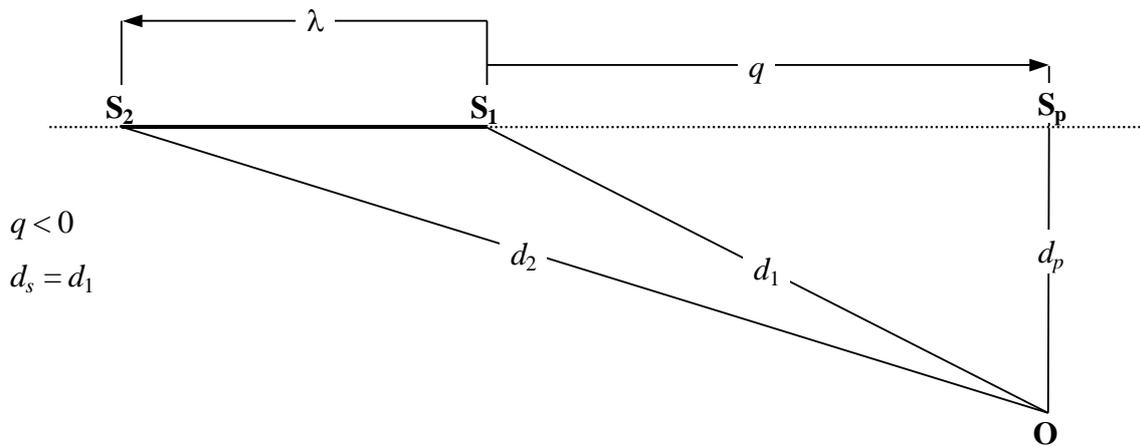
Abbildung 10: Flugbahnsegmentgeometrie bei hinter dem Segment befindlichem Immissionsort
