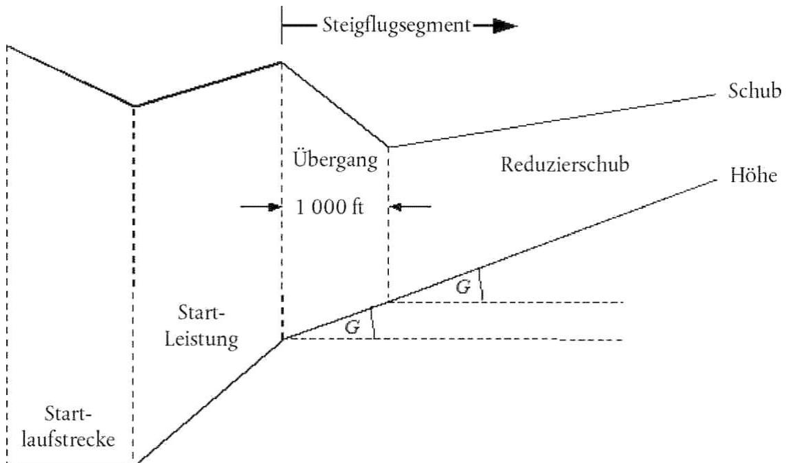
Abbildung B.2: Steigflugsegment mit konstanter Geschwindigkeit und Schubreduzierung (Abbildung nicht maßstabsgetreu)
