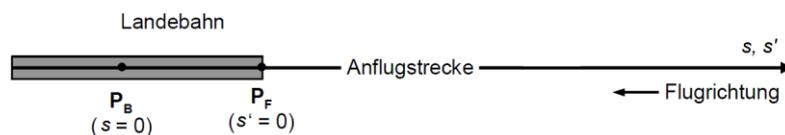
Abbildung 2: Streckenkoordinatensysteme  $s$  und  $s'$
