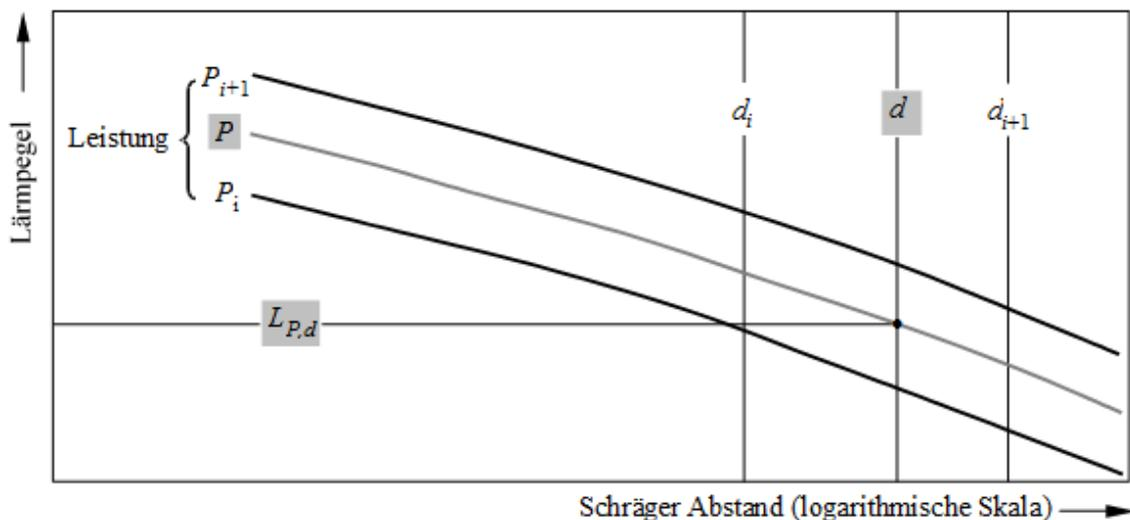
Abbildung 9: Interpolation bei Lärm-Leistung-Abstand-Kurven (NPD-Kurven), auf der Abszisse ist der Schrägabstand (logarithmische Skala) aufgetragen
