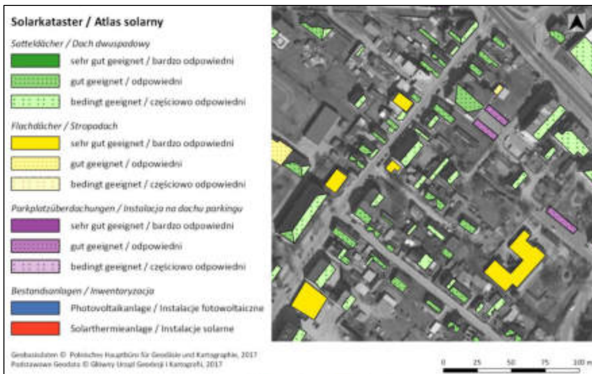
Rys. 76: Wycinek katastru słonecznego dla powierzchni dachowych pojedynczych budynków (ŹRÓDŁO: PRZEDSTAWIENIE WŁASNE EVF 2017)
