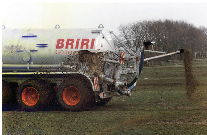
❶ Fig. 18: Distribuitor cap de impact (cu placă deflectoare)
