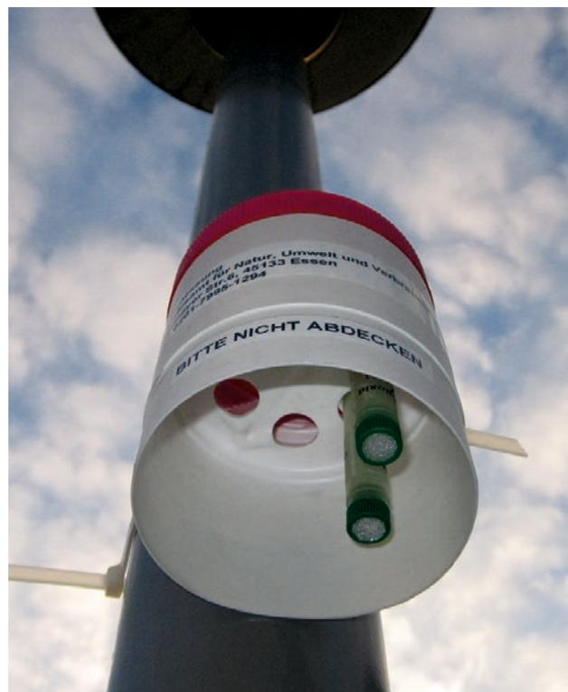
Passivsammler: Ein Passivsammler ist ein kleines, ohne Energie betriebenes Messgerät, in dem mehrere Prüfröhrchen die Schadstoffe aus der Luft aufnehmen. Die Röhrchen werden regelmäßig eingesammelt und der Inhalt im Labor ausgewertet.
