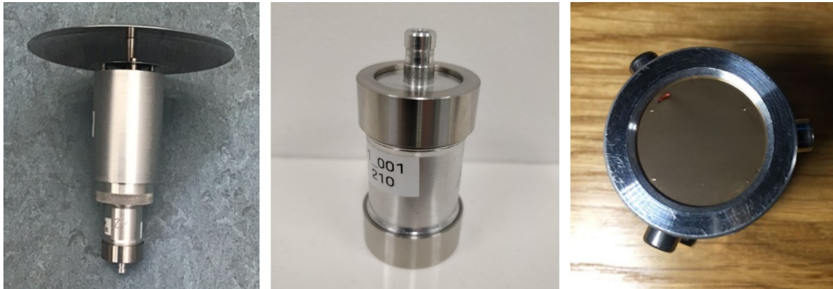
Abbildung 2: Verwendeter Partikelsammler. Links: UBA-Impaktor, Mitte: BAuA-Sammelkopf, Rechts: Vergoldeter Polycarbonat-Kernporenfilter.
