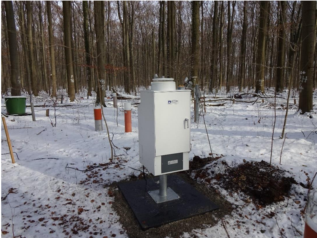
Abbildung 50: Klimatisierter Wet-only-Sammler auf der Buchen-Versuchsfläche im Göttinger Wald
