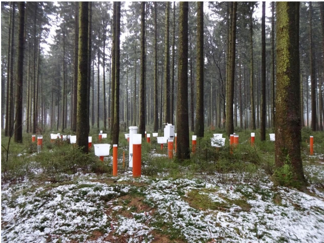
Abbildung 44: Hg-Sammler auf der neuen Fichten-Versuchsfläche im Solling
