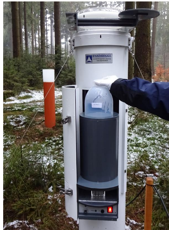
Abbildung 52: Innenansicht des klimatisierten Wet-only- (links) und des Bulk-Sammlers (rechts)
