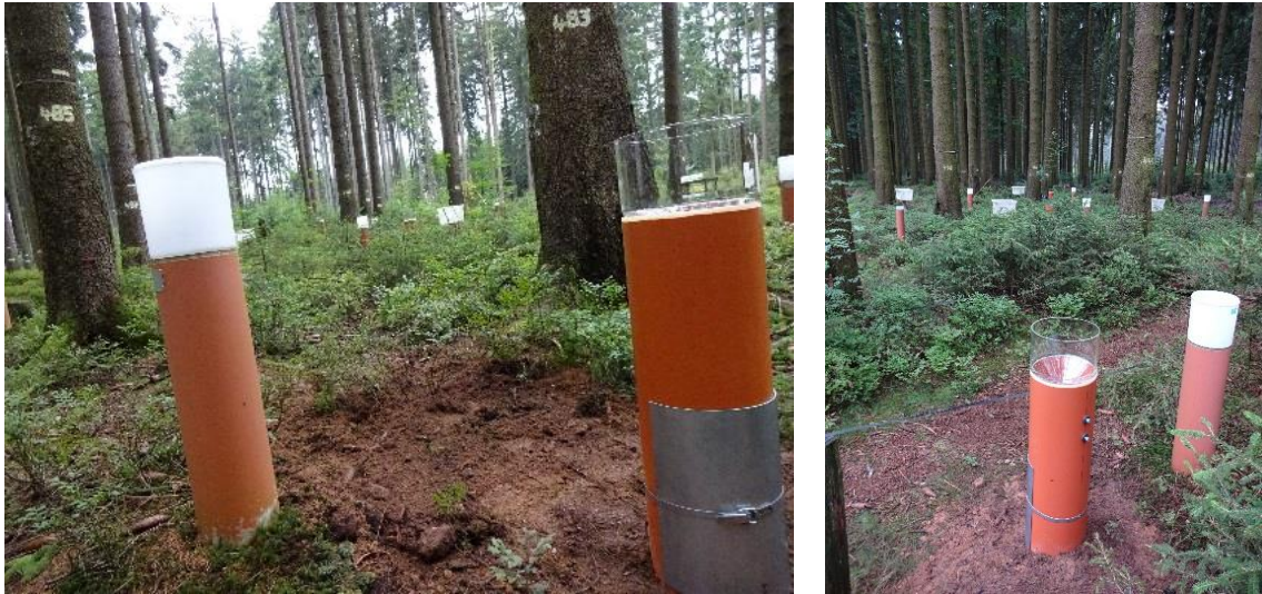
Abbildung 43: Hg-Sammler auf der alten Fichten-Versuchsfläche im Solling
