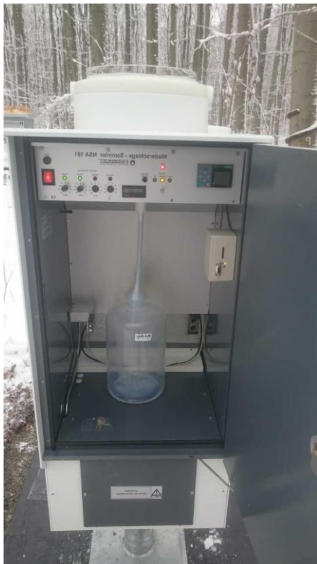
Abbildung 52: Innenansicht des klimatisierten Wet-only- (links) und des Bulk-Sammlers (rechts)
