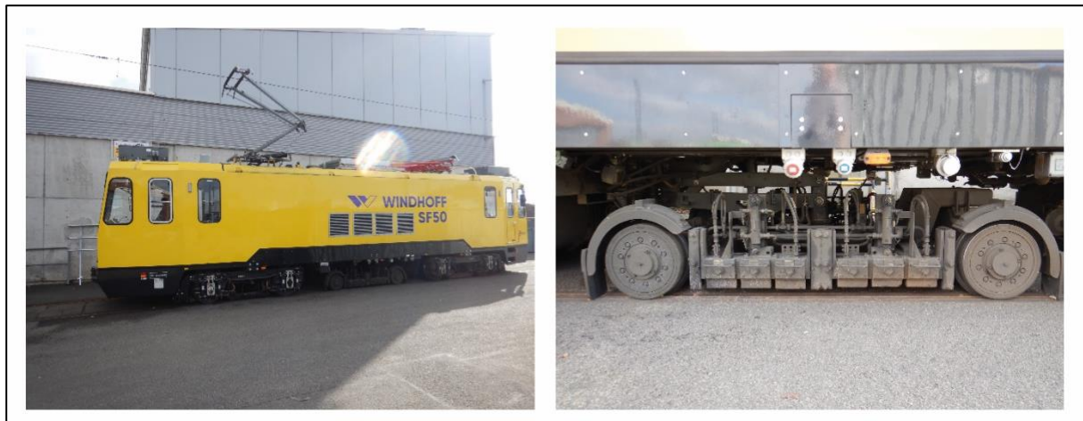
Abbildung 45: Schienenschleifzug mit Rutschersteinen
