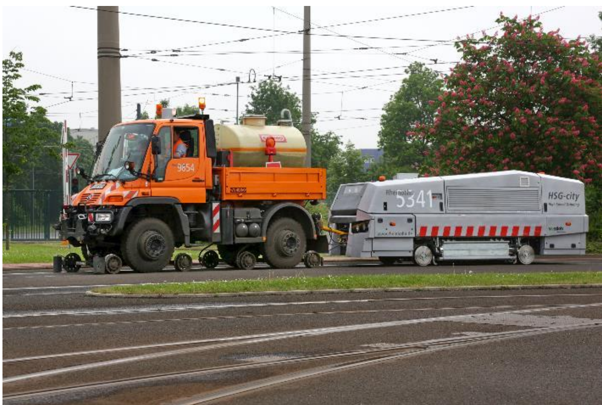
Abbildung 46: Schleifzug „HSG-city“ der Rheinbahn in Düsseldorf
