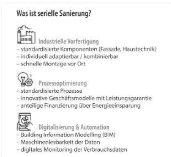
1 Eine serielle Sanierung umfasst die drei Aspekte Vorfertigung, Prozessoptimierung und Digitalisierung & Automation.
