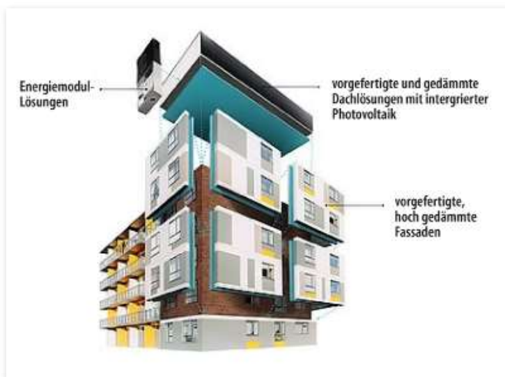
2 Schemazeichnung des seriellen Sanierungsprinzips mit vorgefertigten Bauelementen
