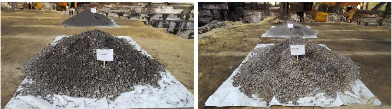
Aufbereitete Schlacke Referenz (links) und aufbereitete Schlacke nTiO<sub>2</sub> (rechts) gegen Ende der 3-monatigen Lagerung
