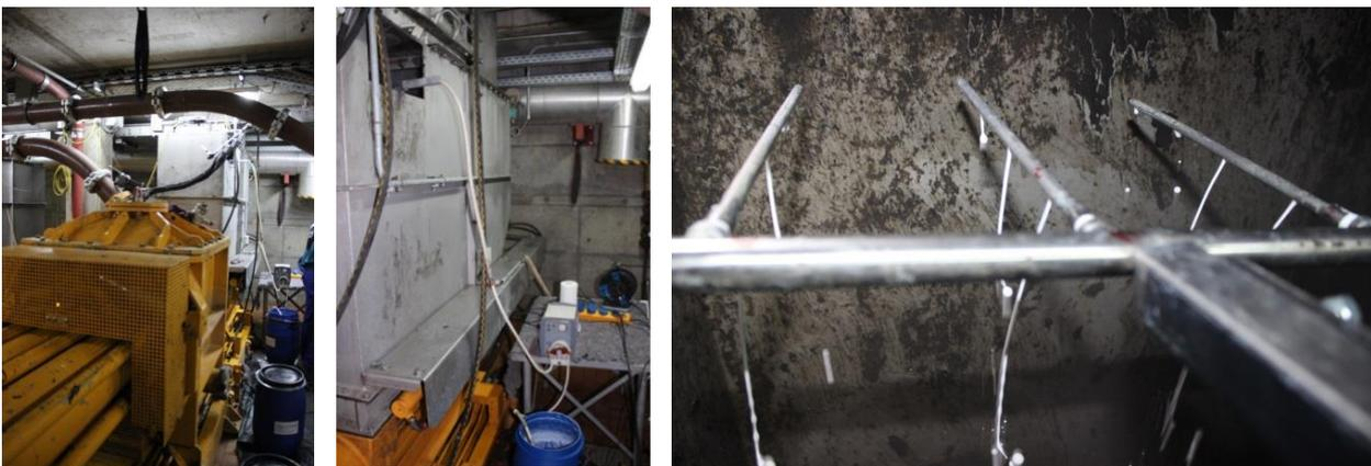
Feststoffpumpe der Fa. Putzmeister (links); Vorrichtung zur Einbringung der Nanomaterial-Suspension mit Vorlagebehälter, Waage und Schlauchpumpe (Mitte); Dreizack zur Einbringung der Titandioxid-Suspension in den Klärschlamm (rechts)
