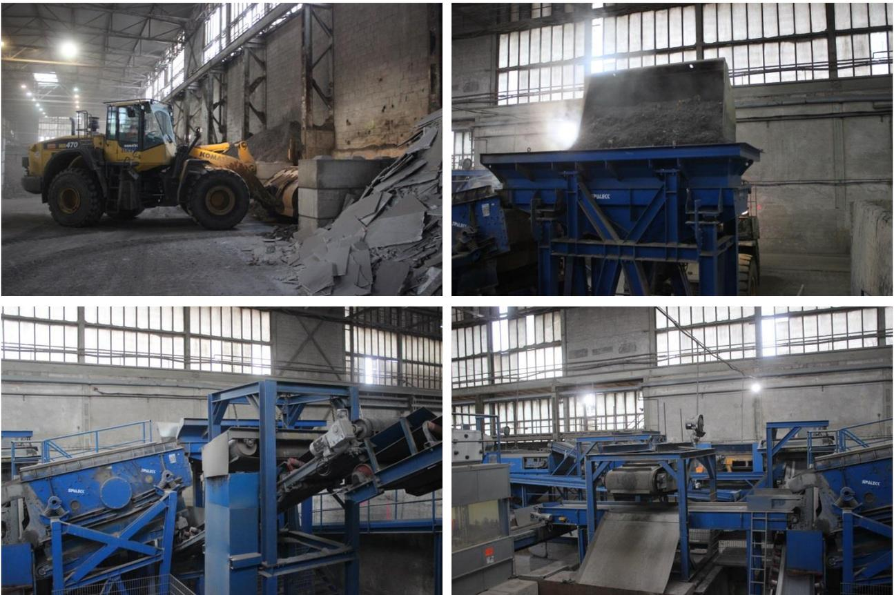
Aufgabe der Rohschlacken mittels Radlader (oben); Aufbereitungsanlage der MAV Kelheim
