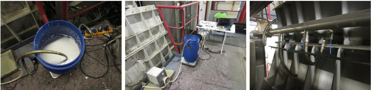
nTiO<sub>2</sub>-Suspension (links), Vorrichtung zur Einbringung der Nanomaterial-Suspension mit Vorlagebehälter, Waage und Schlauchpumpe (Mitte); Löschwasserdüsen zur Einbringung der Titandioxid-Suspension in den Brennstofftrichter (rechts)
