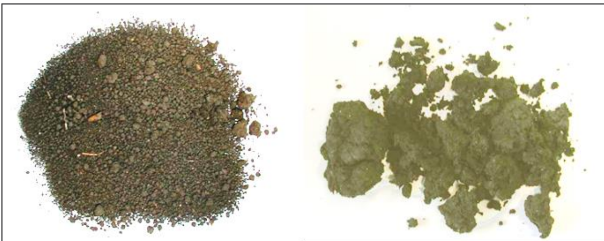
Abbildung 17: Klärschlamm, links getrocknete Klärschlammpellets (Trockensubstanz > 85 %); rechts feuchter Klärschlamm (Trockensubstanz < 30 %)
