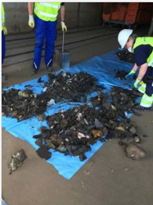
Abbildung 22: Verjüngung Mischprobe SLF Schredderanlage 1
