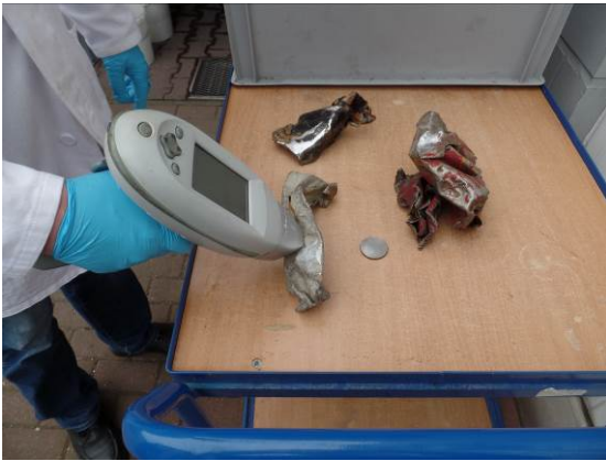
Abbildung 29: Messung eines Stahlteils mit mobiler RFA
