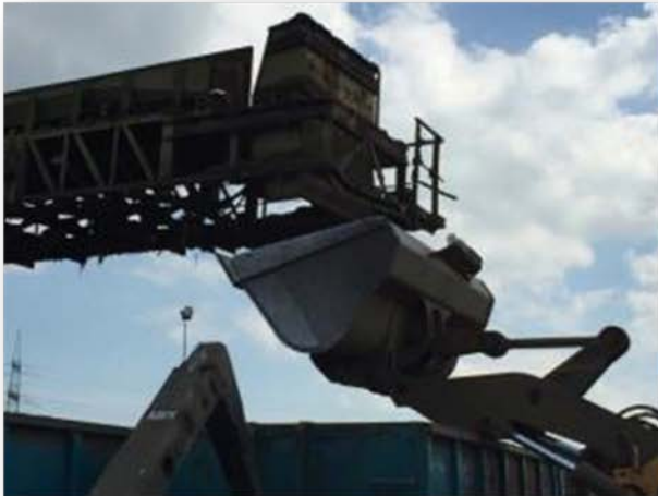
Abbildung 19: Links: Radlader bei Einzelprobenentnahme aus Fallstrom Stahlprodukt Schredderanlage 1; rechts: Radladerschaufel mit Einzelprobe Stahlprodukt Schredderanlage 1
