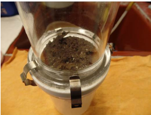
Abbildung 31: Filtrerrückstand der Abwaschlösung mit den Anhaftungen an den Stahlteilen der Probe 1.3
