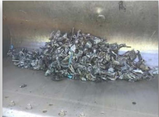
Abbildung 19: Links: Radlader bei Einzelprobenentnahme aus Fallstrom Stahlprodukt Schredderanlage 1; rechts: Radladerschaufel mit Einzelprobe Stahlprodukt Schredderanlage 1
