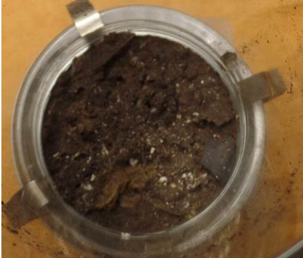
Abbildung 32: Vergrößerung des Filtrerrückstandes der Abwaschlösung mit den Anhaftungen an den Stahlteilen der Probe 1.3
