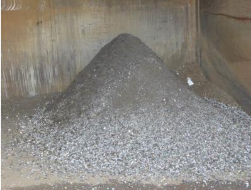
Abbildung 157: Probenmatrix Probe 3 (Schredderanlage 2) Schredderschwerfraktion nach Aufbereitung
