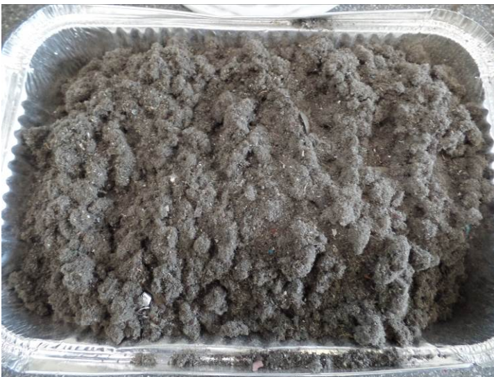
Abbildung 68: Laborprobe SLF (Probe 4) für die chemische Analytik nach Zerkleinerung auf < 0,5 mm der Firma 1
