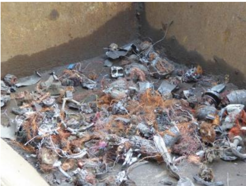
Abbildung 156: Probennahmestelle 2 (Schredderanlage 2) Cu-Fe nach Handklaubung
