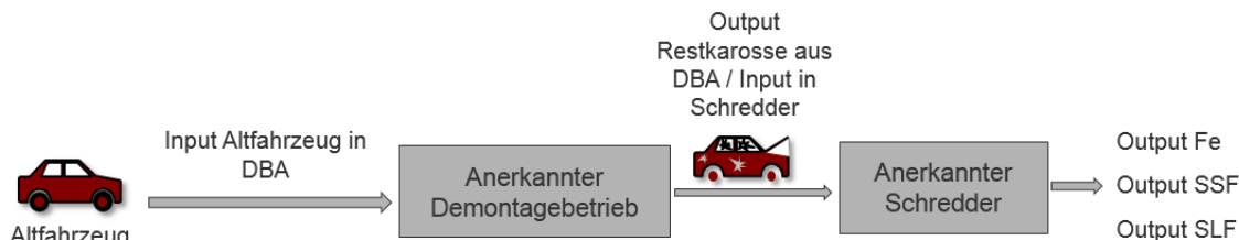
Abbildung 94: Skizze des zweistufigen Verwertungsverfahrens von Altfahrzeugen
