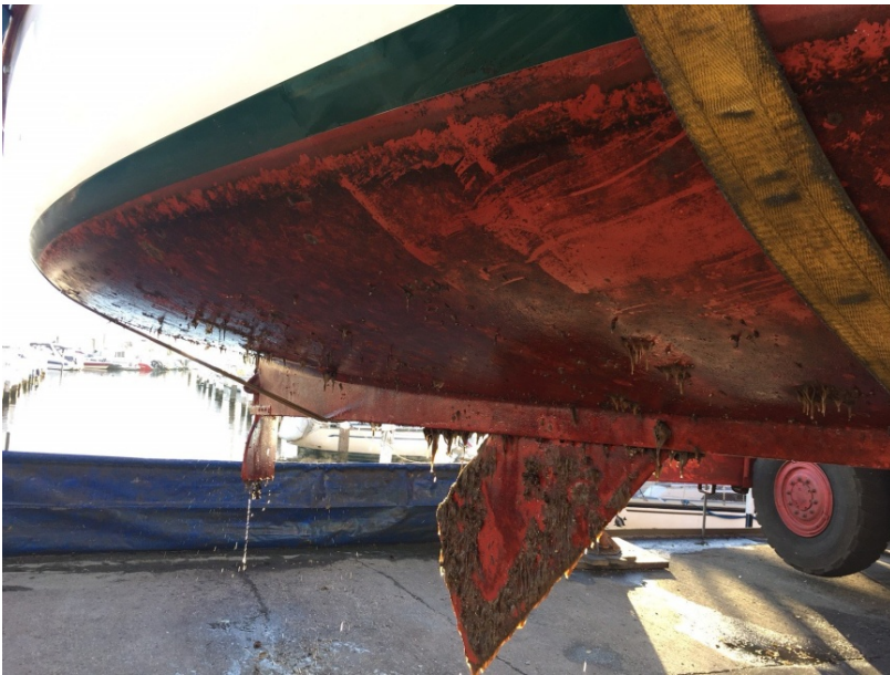
Abbildung 6: Jollenkreuzer mit Antihafbeschichtung nach der Saison ungereinigt
