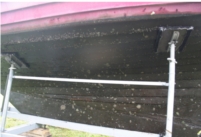
Abbildung 8: Erodierende Beschichtung ohne toxische Zusätze nach einer Saison im Süßwasser
