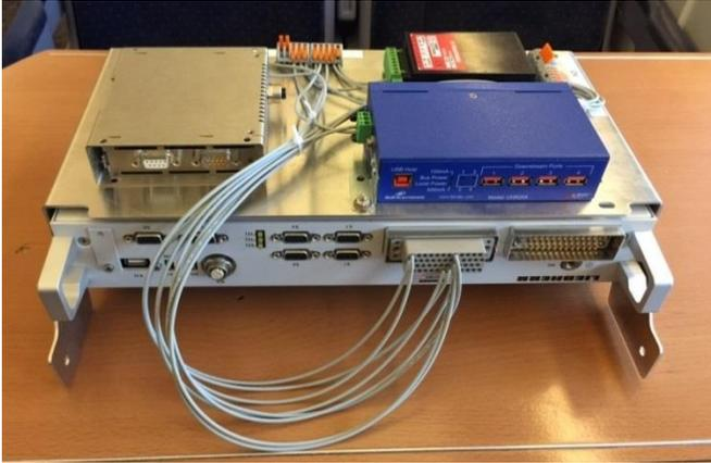
Schaltschrankmodul mit Messtechnik für den Wagen TW7. Quelle: eigene Darstellung, Liebherr
