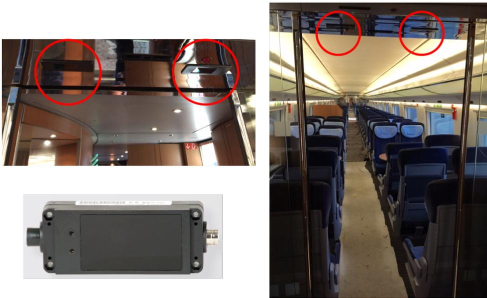
Eingebaute Sensoren der Besetzungszählung in den Durchgängen des Wagens TW7 (links oben und rechts) und ein einzelner Sensor (links unten). Quelle: eigene Darstellung, Liebherr
