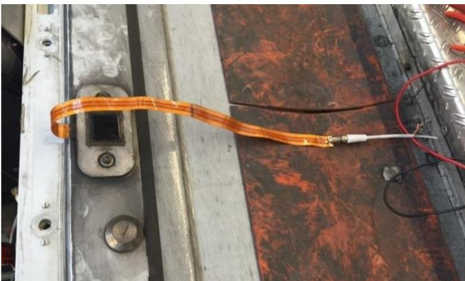
Defekte Solarzelle (Kabelbruch) am Klimagerät des ICE 3 Wagens TW7. Quelle: eigene Darstellung, Liebherr
