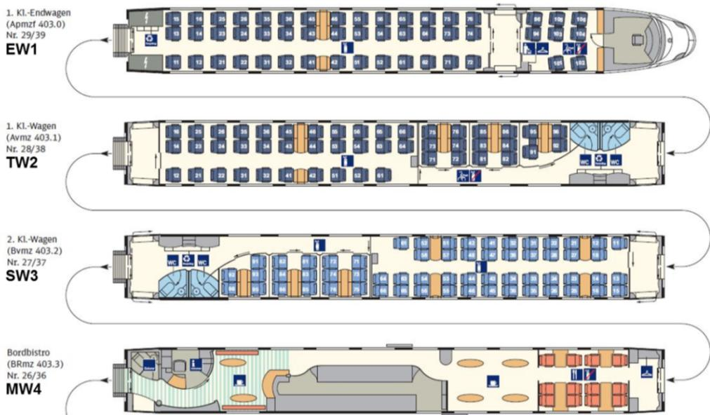
Gesamtübersicht des ersten Halbzuges (Wagen 1 bis 4), Quelle: (Deutsche Bahn AG, Fahrzeuglexikon für den Fernverkehr 2016, 2017).
