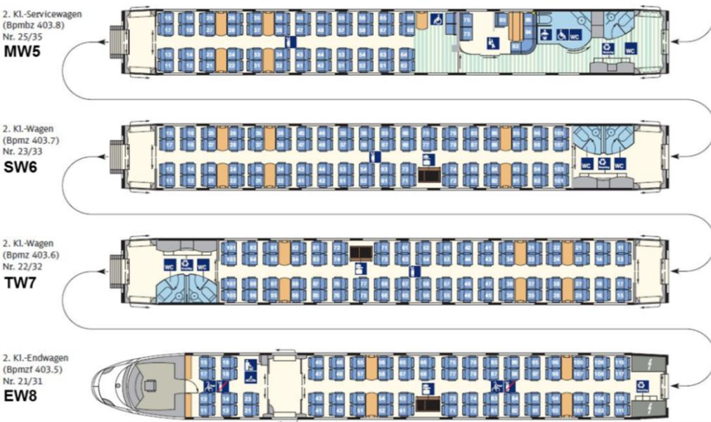
Gesamtübersicht des zweiten Halbzuges (Wagen 5 bis 8). Quelle: (Deutsche Bahn AG, Fahrzeuglexikon für den Fernverkehr 2016, 2017).
