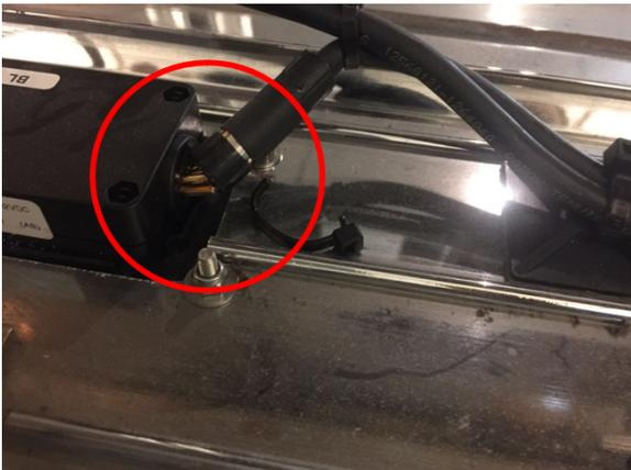
Beschädigung am Sensorkabel des DILAX-Sensors zur Besetzungszählung. Quelle: eigene Darstellung, Liebherr
