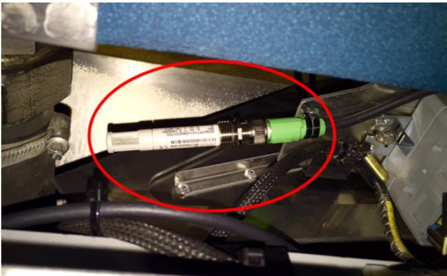
Eingebauter Temperatur- und Feuchtesensor im TW2 (analog zum TW7). Quelle: eigene Darstellung, Liebherr
