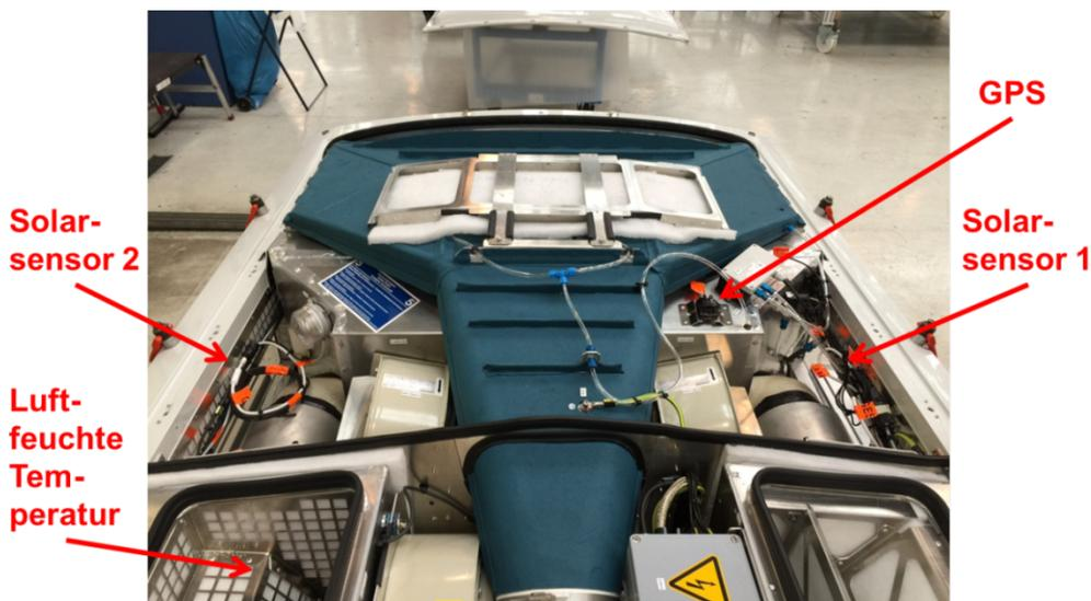
Positionen des GPS und der eingebauten Sensoren für Solarstrahlung, Luftfeuchte/ Temperatur und deren Anschlüsse im Kompaktklimagerät Nr. 4 im Dach des ICE 3 - Wagens TW7. Quelle: eigene Darstellung, Liebherr
