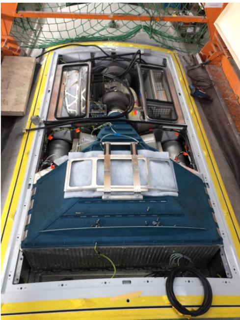
Im Dach des Wagens TW7 eingebautes Kompaktklimagerät Nr. 4 mit zusätzlicher Sensorik und Verkabelung (orange markiert). Quelle: eigene Darstellung, Liebherr
