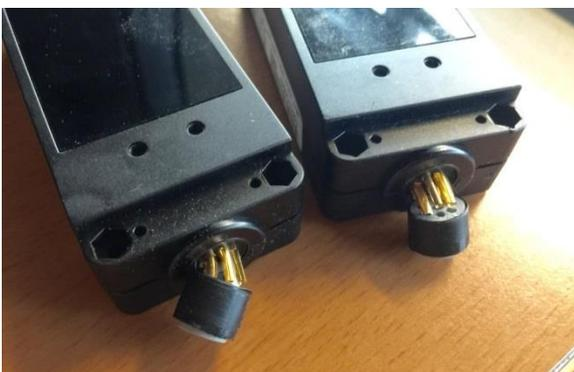
Beschädigungen der DILAX-Sensoren zur Besetzungszählung. Quelle: eigene Darstellung, Liebherr
