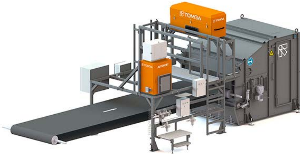
Abbildung 63: sensorbasiertes automatisches Sortiersystem
