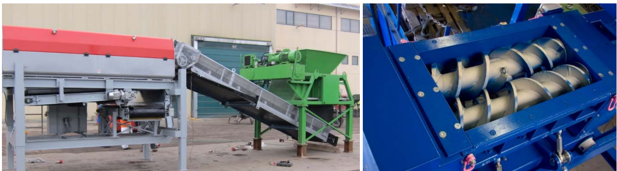
Abbildung 59: Sackaufreißer und langsam laufendes Zerkleinerungsaggregat
