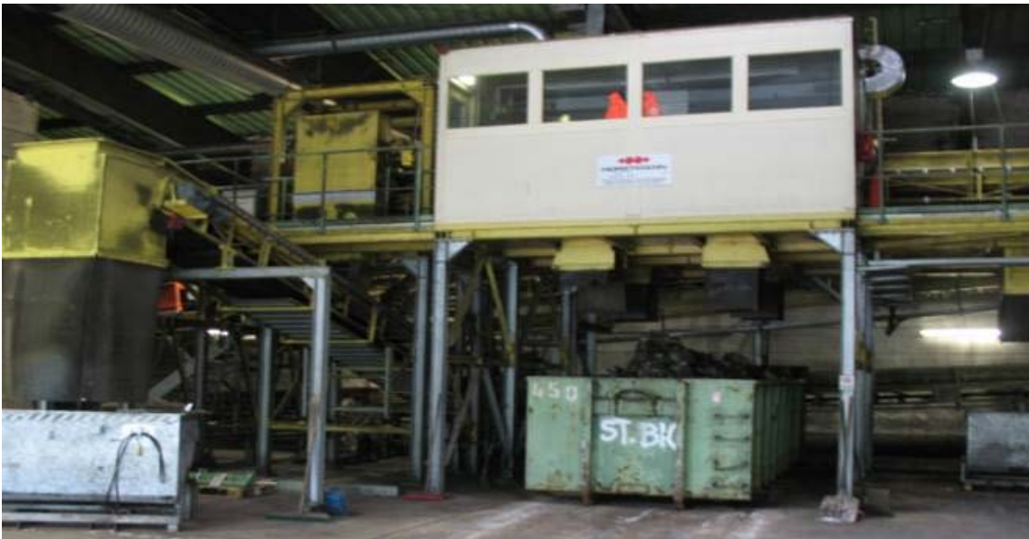
Abbildung 71: Sortierkabine zur händischen Separierung der Fremdstoffe
