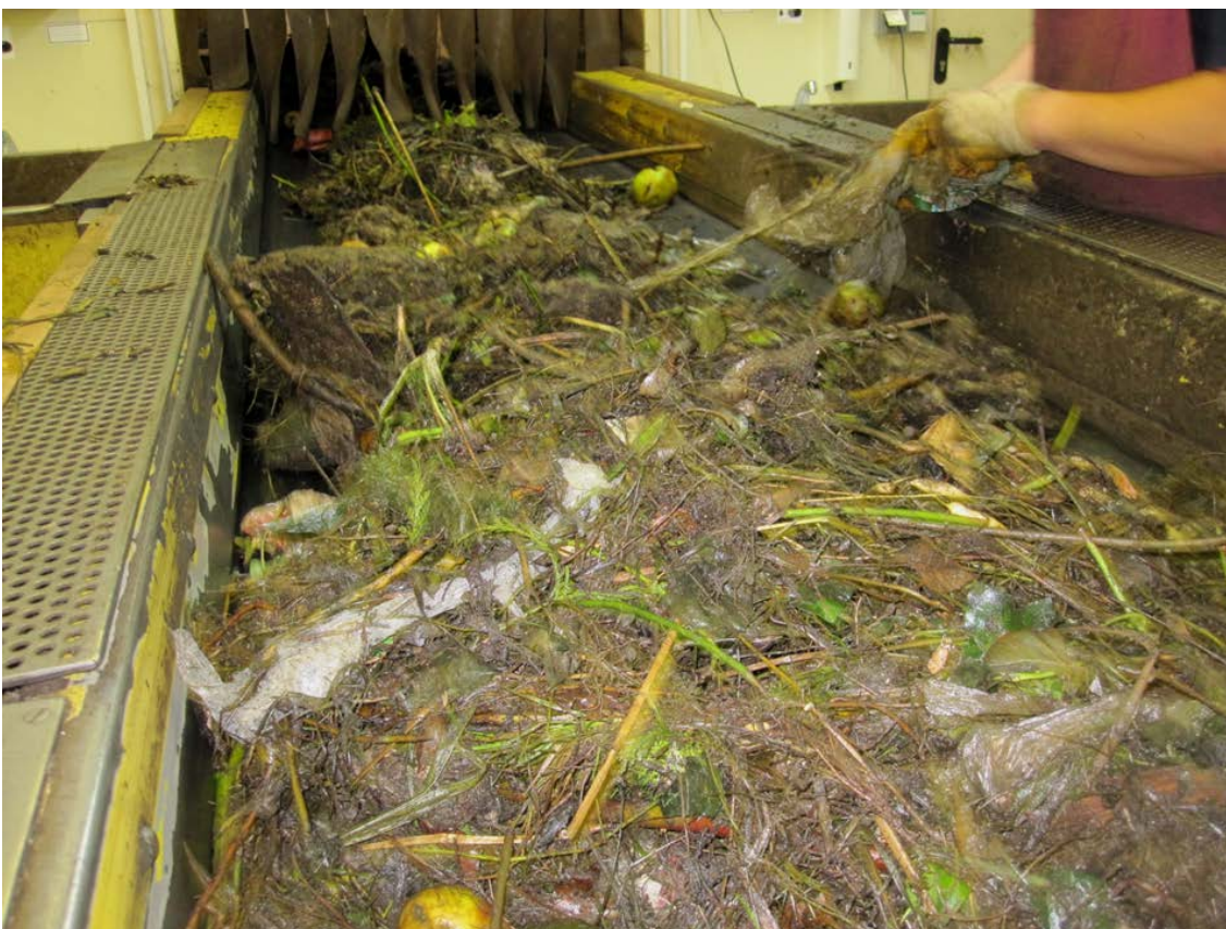
Abbildung 72: Sortierband zur händischen Separierung der Fremdstoffe
