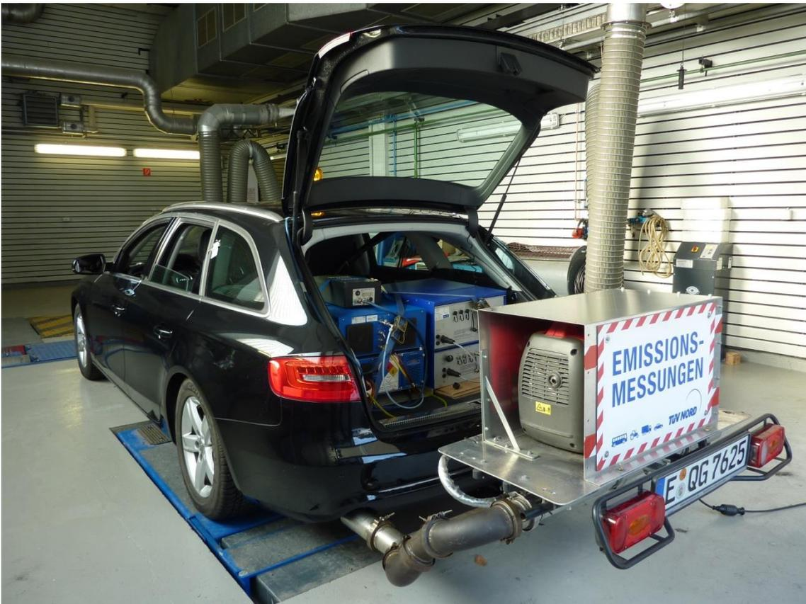
Abbildung 18: Installation des PEMS-Systems am Prüffahrzeug – VW Passat
