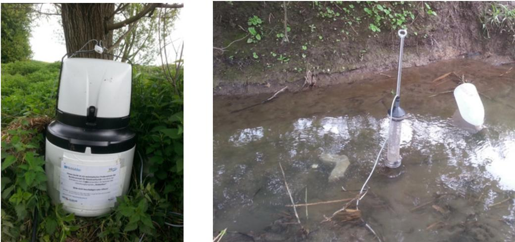
Linke Abbildung: Mobiler automatischer Probensammler P6 L der Firma MAXX Mess- und Probenahmetechnik GmbH (Rangendingen) im Geländeeinsatz. Das Gerät ist abschließbar. Es wurde zusätzlich mit zwei verschließbaren Haltebügeln gesichert und mit Drahtseilen an einem Baum angeschlossen.
