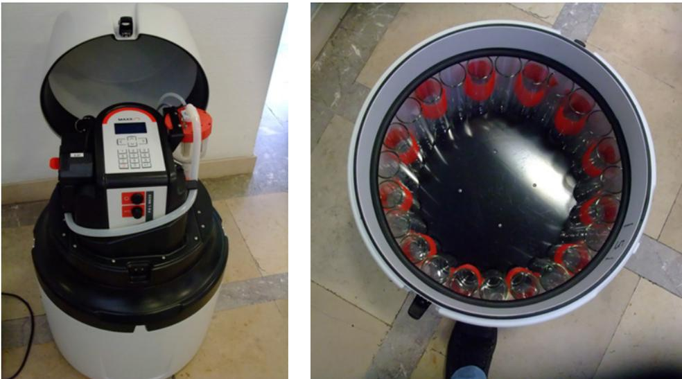
Durchmesser des Gerätes: 50 cm, Höhe: 74 cm, Gewicht ohne Akku: ca. 12 kg) von. Mit der hier gezeigten Geräteausführung können bis zu 24 Mischproben à 350 mL entnommen werden.
