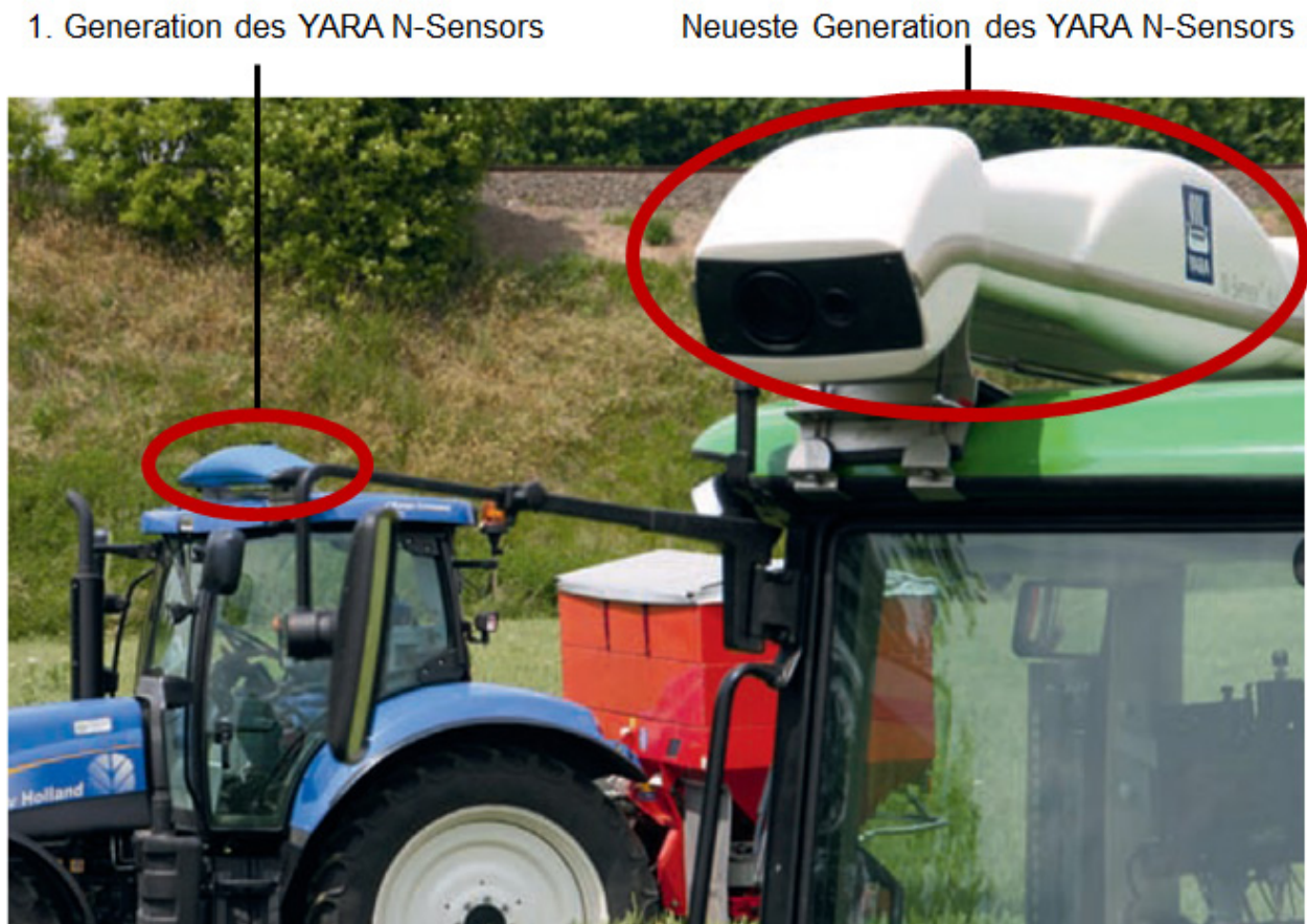
Abbildung 2-27: YARA N-Sensor® auf dem Traktor montiert (Photo: tec 5, 2014; Zusätzlich rote Kreise mit freundlicher Genehmigung von tec5)
