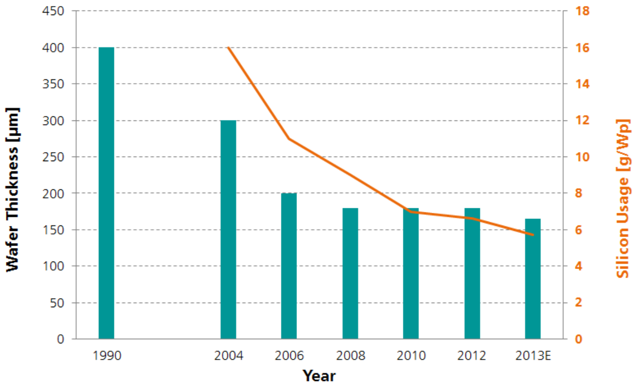
Abbildung 2-9: Halbleiter-Schichtdicken von Si-Dickschichtzellen
