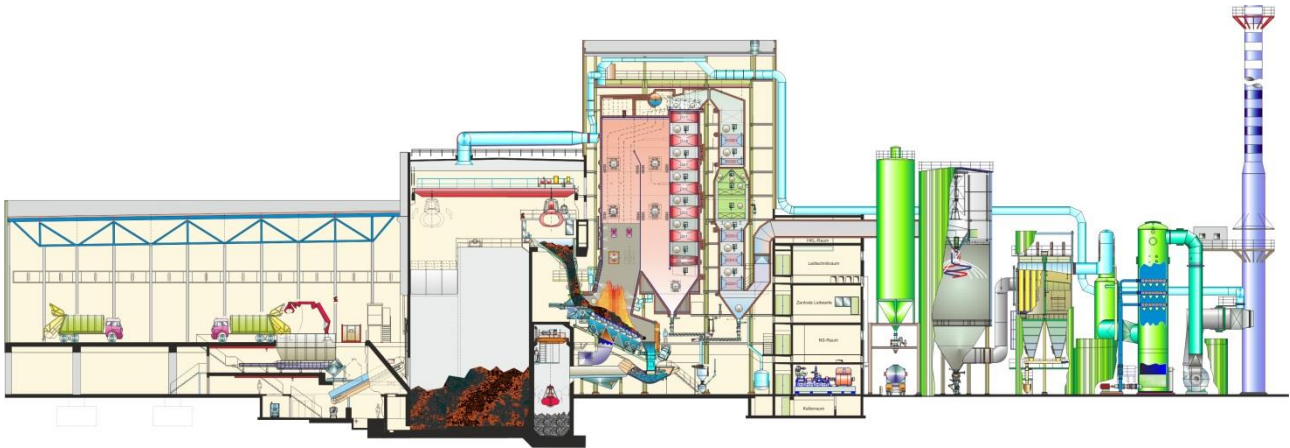
Abbildung 3-3: Schema des MHKW Mainz (Längsschnitt)
