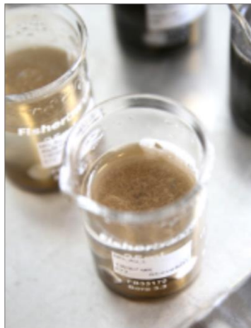
Abbildung 3-17: Methodisches Vorgehen bei der Eindickung (rechts), verwendete Apparaturen (links) und Bechergläser mit gebildetem Flotat (Mitte)
