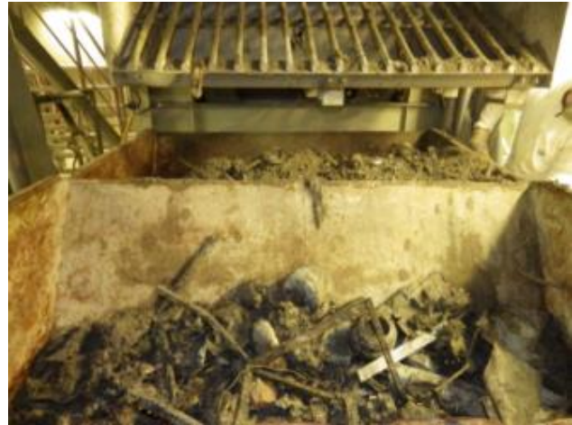
Abbildung 3-5: Stangensieb zur Trennung (bei 100 mm) und Loren zur Erfassung der Schlacken. Feinfraktion (hintere Lore) und Überkorn (Vordergrund) Nassentschlackung (Bild rechts)
