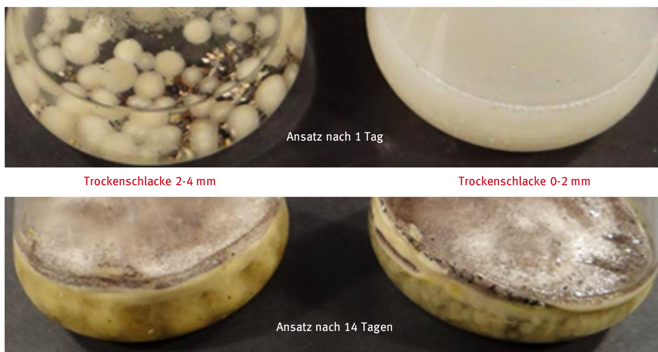
Abbildung 4-41: Erlenmeyerkolben mit Kulturen von Aspergillus niger nach 1 Tag (oben) und 14 Tagen (unten) Inkubation mit Trockenschlacke (links: 2-4 mm, rechts: 0-2 mm)
