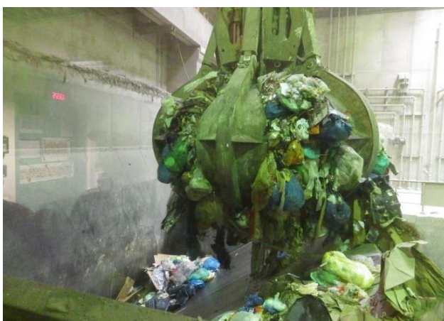
Abbildung 3-4: Vorgemischter Müll bei der Aufgabe in den Trichter (links) und Blick in Feuerung (rechts)
