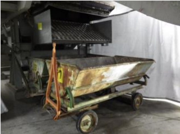
Abbildung 3-5: Stangensieb zur Trennung (bei 100 mm) und Loren zur Erfassung der Schlacken. Feinfraktion (hintere Lore) und Überkorn (Vordergrund) Nassentschlackung (Bild rechts)
