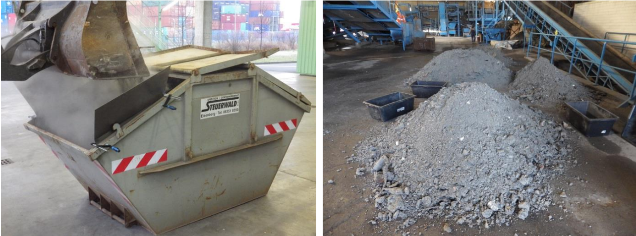
Abbildung 3-7: Transportcontainer (links) und dreimonatige Zwischenlagerung (rechts) der Nassschlacke
