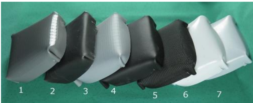
Abbildung 4: Prüfkörper der untersuchten Dachfolien
