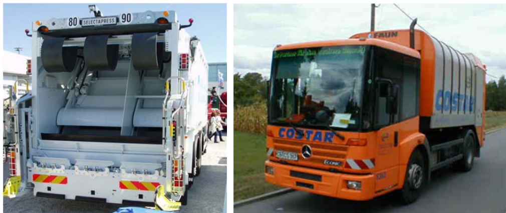
Figure 14: Benne à deux chambres pour le ramassage parallèle séparé de 2 fractions (à gauche) et benne à tambour rotatif cabine basse, modèle « Econic » (à droite) (Sources à gauche, à droite: Intecus GmbH)
