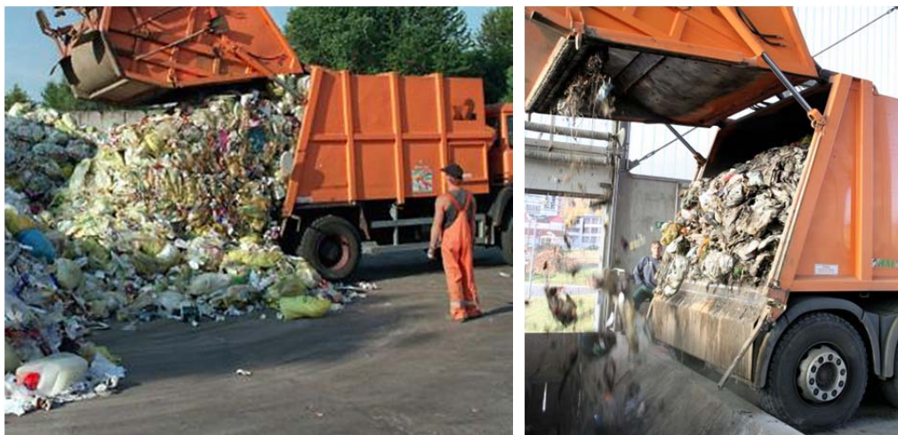
Figure 15: Déchargement de la benne à chargement arrière par la plaque de compactage (à gauche, à droite) Source à gauche : Intecus GmbH, Source à droite : Petra Hoeß, FABION Markt + Medien, www.abfallbild.de
