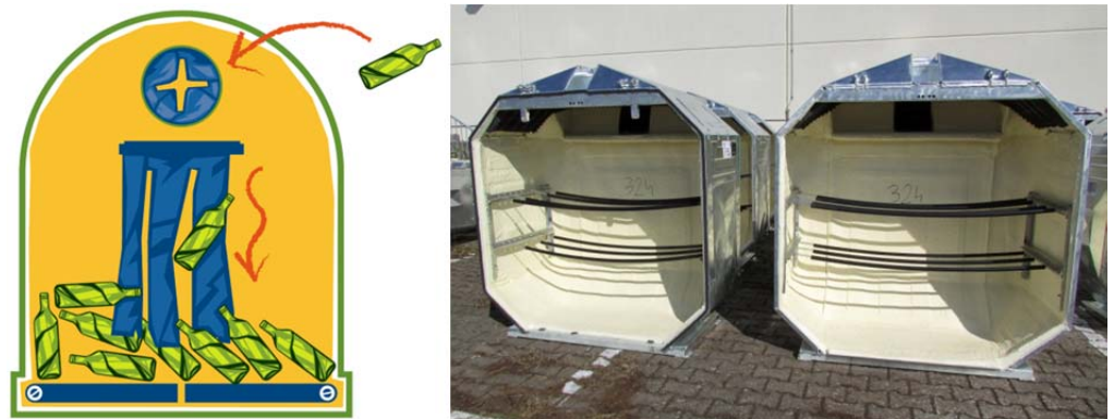
Figure 10: Coupe d'un conteneur de dépôt équipé d'un amortisseur de chute et d'un tapis d'insonorisation (Source à droite : Harald Heinritz, www.abfallbild.de )
