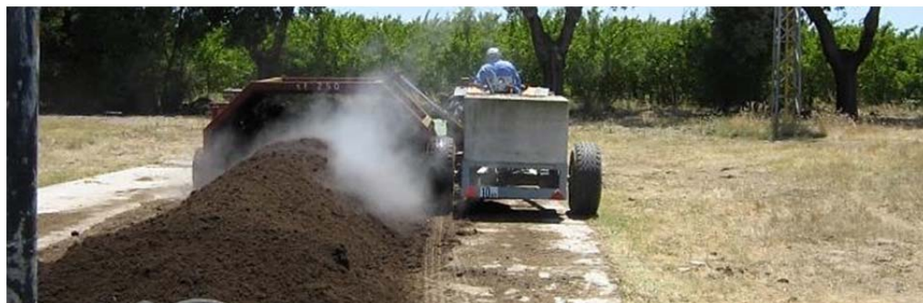
Figure 9: Exemple d'une ventilation active par procédé dynamique avec manutention (Source : Intecus)
