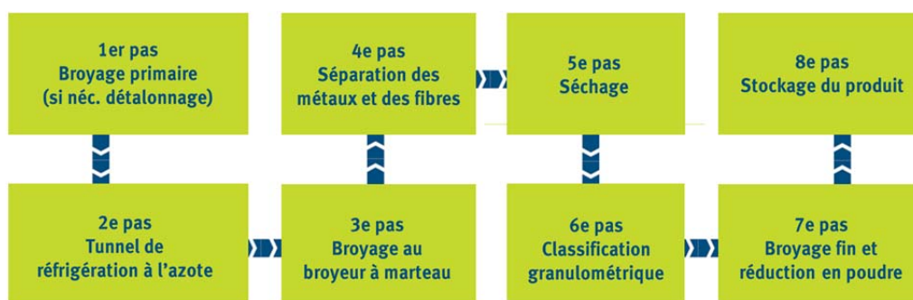
Figure 4: Principales étapes du procédé de broyage à froid
