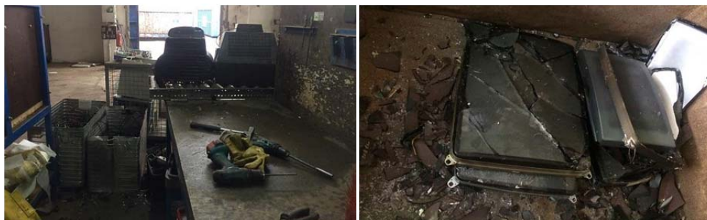
Figure 16: Atelier de désassemblage manuel des écrans (à gauche) et verre d'écran démonté (à droite) (Source à gauche & à droite : INTECUS GmbH)
