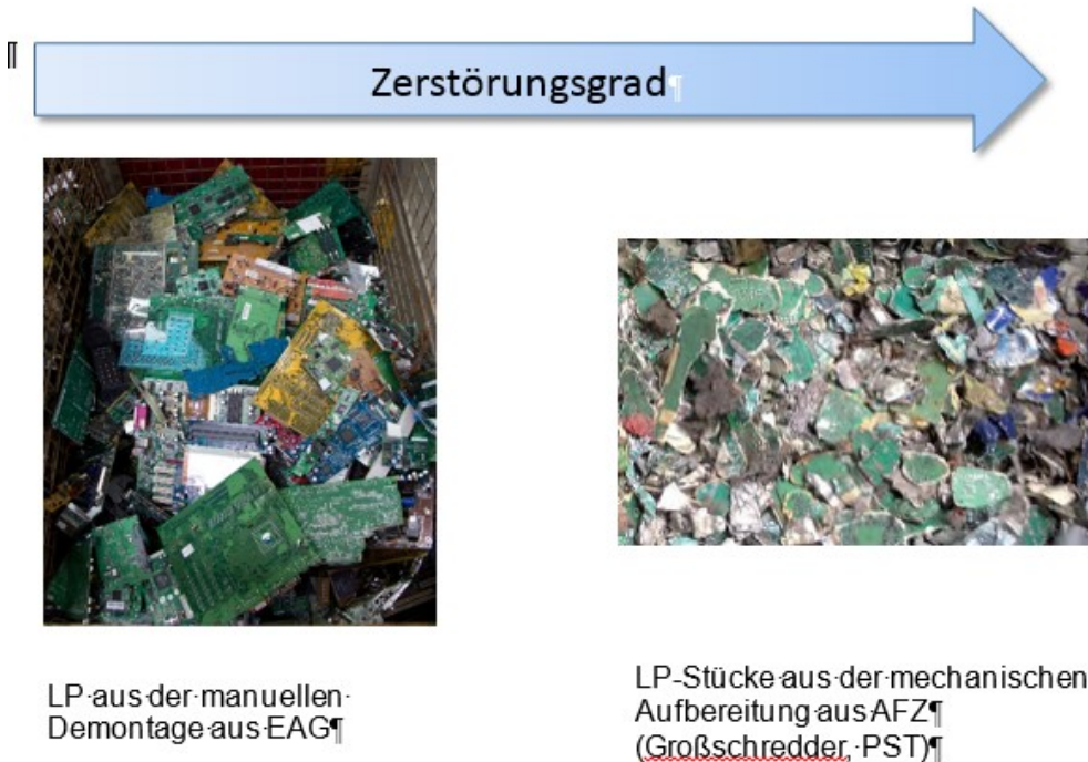
Abbildung 6: Beispiele von Leiterplatten mit unterschiedlichen Zerstörungsgraden
