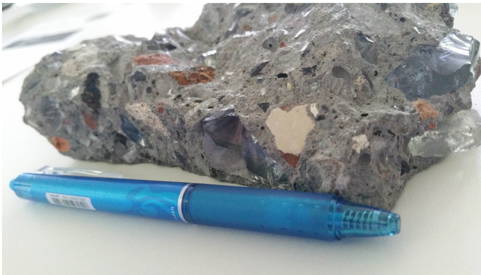
Abbildung 15: Beispiel für die Nutzung von Bildschirmglas als Betonzuschlagstoff (aufgebrochener Betonbaustein)
