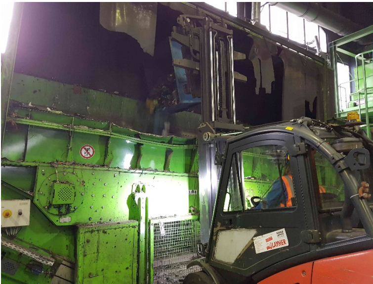
Abbildung 56: Aufgabe Kunststofffraktion aus Werkzeugen in Granulator
