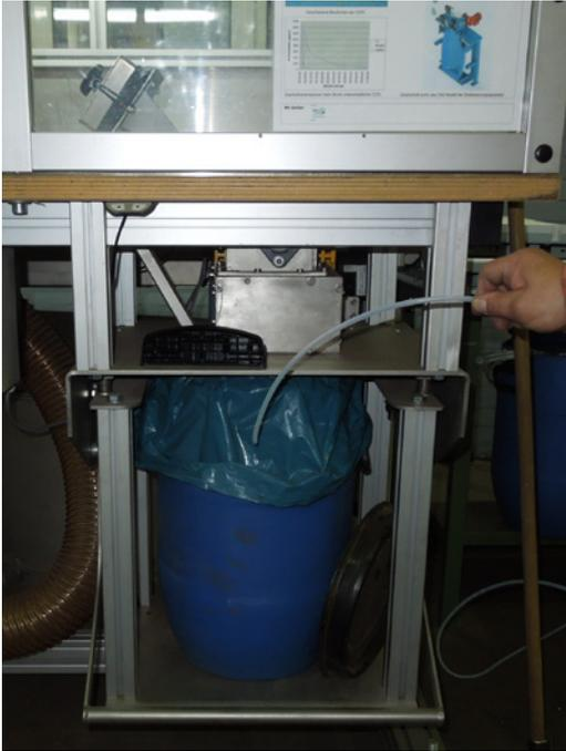
Abbildung 30: Luftdicht eingebauter Sammelbehälter für zerstörte CCFL-Röhren, Zugang über Shredder in Sicherheitswerkbank
