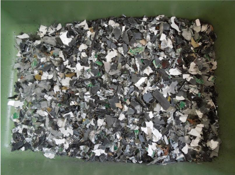
Abbildung 39: Shredderausgangsmaterial
