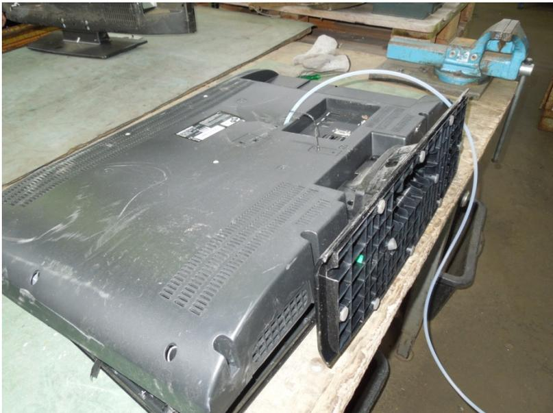
Abbildung 23: Messung innerhalb beschädigtem LCD-CCFL-Fernseher von der Rückseite (Gerät 4)
