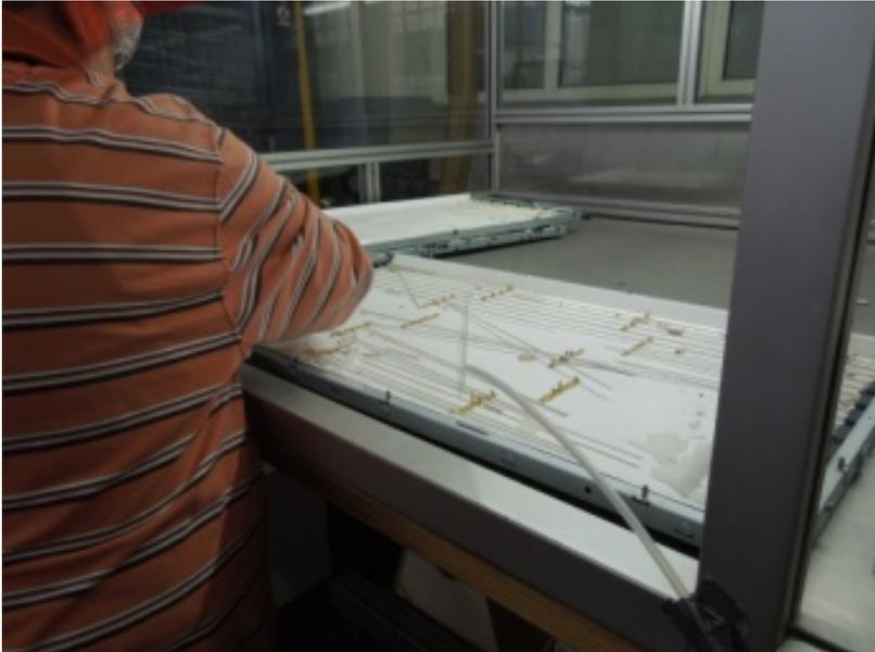
Abbildung 27: Messung der Quecksilberkonzentration im Arbeitsbereich des Bedieners bei der Entnahme von CCFL-Röhren
