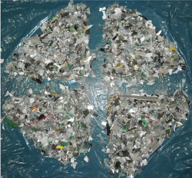
Abbildung 42: Probenteilung als Vorbereitung zur Analyse von LCD-CCFL-Geräten (Fernseher 1)
