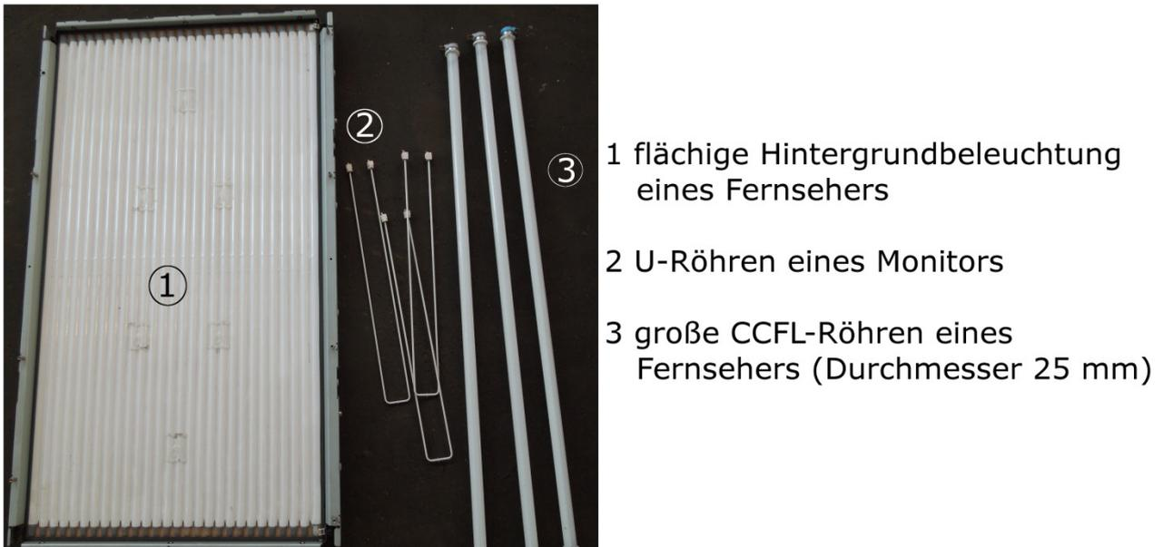
Abbildung 12: Sonderbauformen von CCFL-Hintergrundbeleuchtungen
