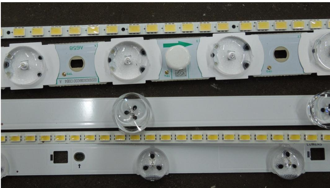
Abbildung 15: Verschiedene LED-Hintergrundbeleuchtungen
