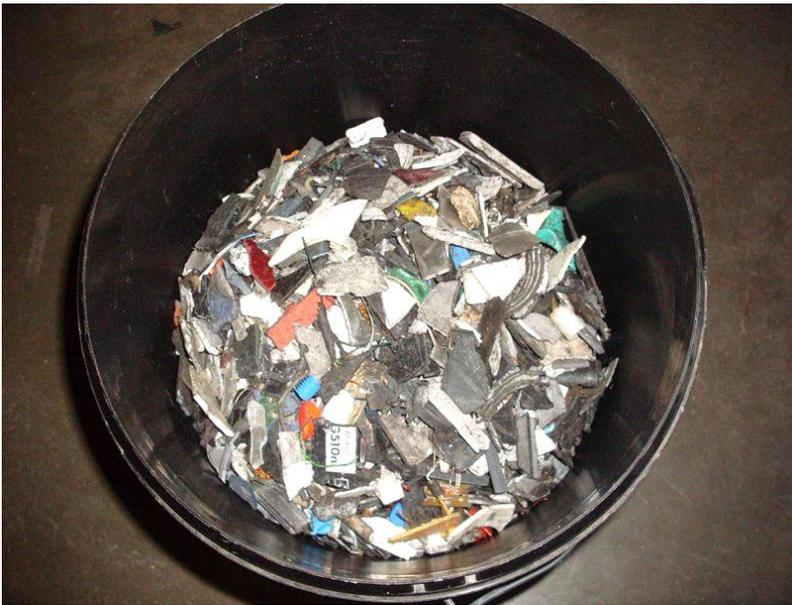
Abbildung 58: Probenahme der nichtmetallischen Restfraktion
