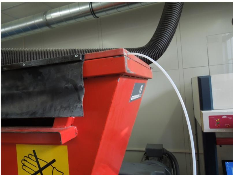
Abbildung 33: Probegasleitung zur Messung innerhalb des Einwellenzerkleinerers
