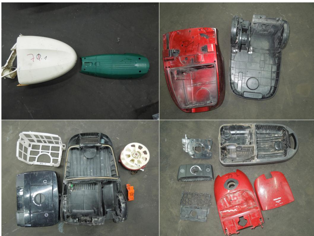
Abbildung 70: Untersuchte Teile von Staubsaugern
