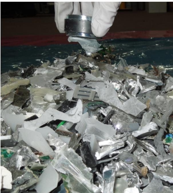
Abbildung 43: Bildung einer Eisenfraktion mit Hilfe eines Magneten
