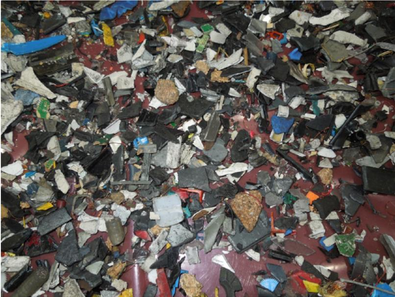
Abbildung 60: Vielfalt der Teile und Materialien der NMRF (Probe 2)
