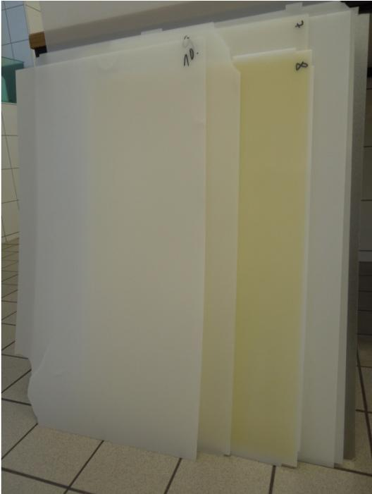
Abbildung 72: Untersuchte dünne, milchig-trübe Streuscheiben von LCD-Fernsehern
