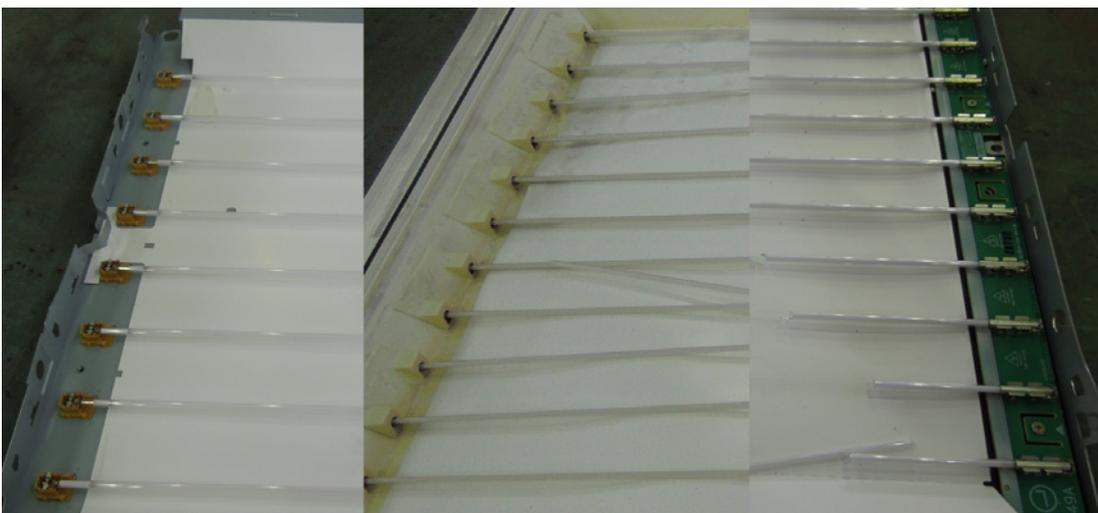
Abbildung 37: Verschiedene Befestigungen von CCFL-Röhren in LCD-Flachbildschirmgeräten
