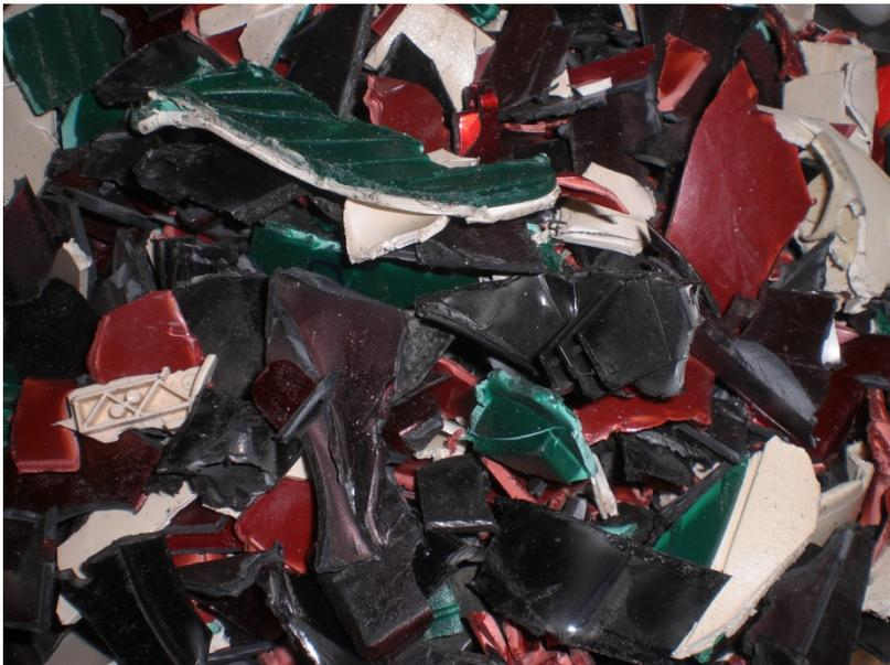
Abbildung 76: ABS aus Staubsaugergehäusen nach Zerkleinerung mit Zweiwellenzerkleinerer von ARP
