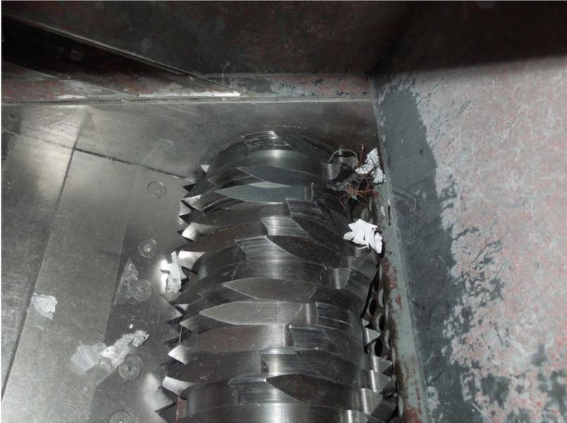
Abbildung 34: Zerkleinerungswelle im Inneren des Einwellenzerkleinerers
