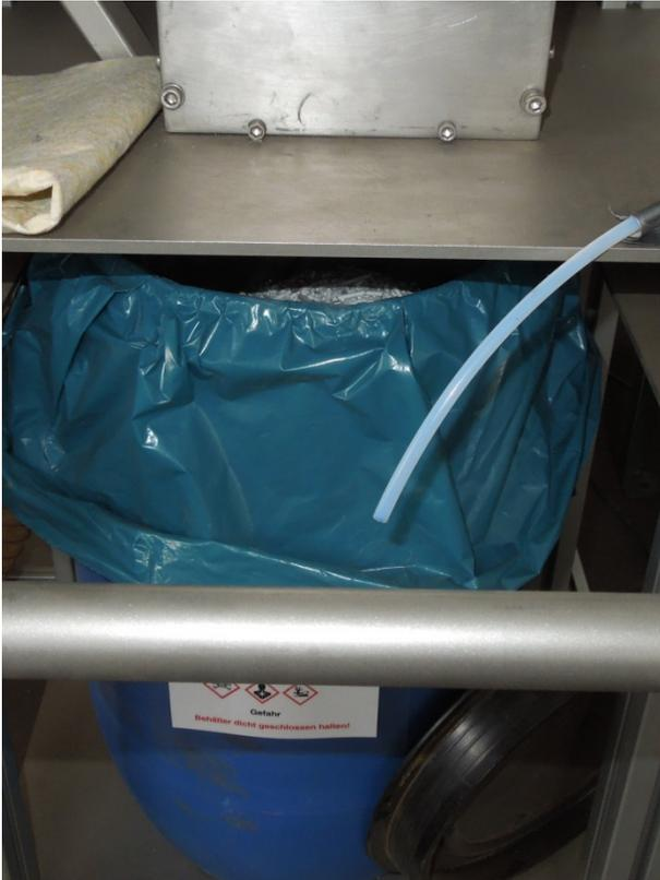
Abbildung 31: Quecksilbermessung am abgesenkten Sammelbehälter für CCFL-Röhren
