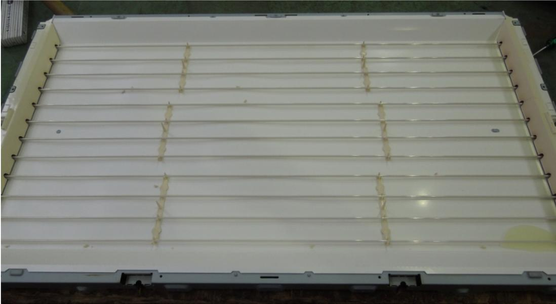
Abbildung 36: CCFL-Röhren in einem Fernseher mit seitlicher Metallabdeckung und mittleren Halterungen
