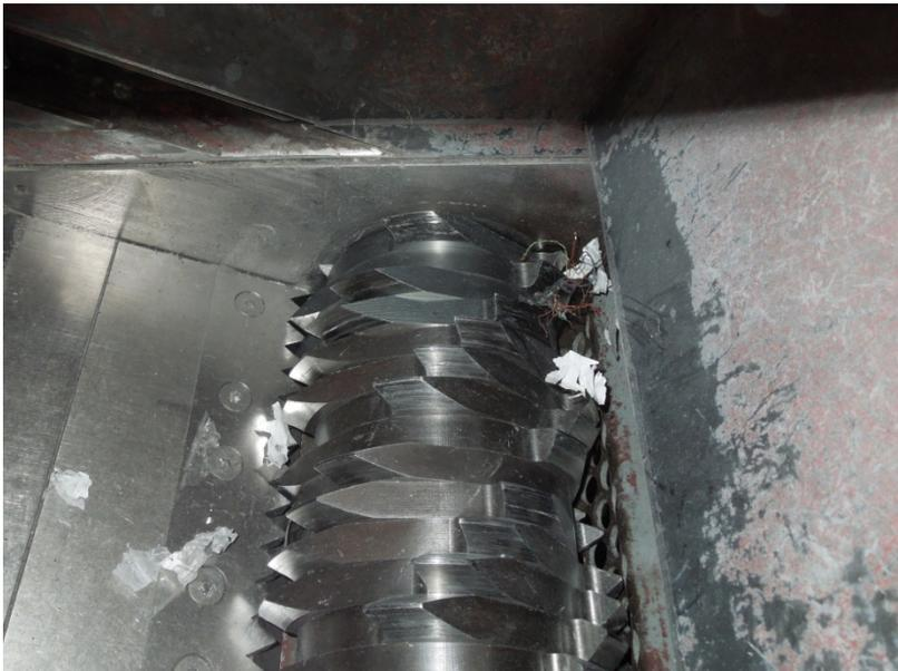
Abbildung 38: Zerkleinerungswelle im Inneren des Einwellenzerkleinerers
