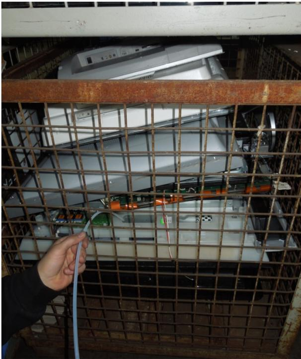
Abbildung 20: Messung der Quecksilberkonzentration bei der Anlieferung von Flachbildschirmen in Gitterboxen
