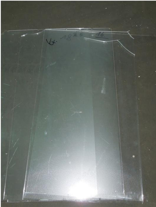
Abbildung 73: Untersuchte dicke, durchsichtige Streuscheiben von LCD-Fernsehern
