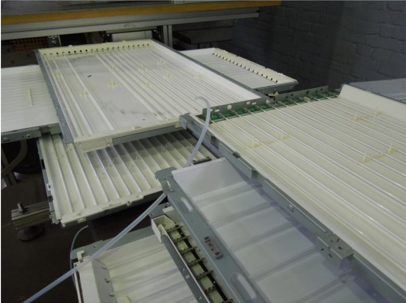
Abbildung 24: Messung der Quecksilberkonzentration bei der Lagerung von teilzerlegten LCD-CCFL-Geräten mit unzerstörten Röhren
