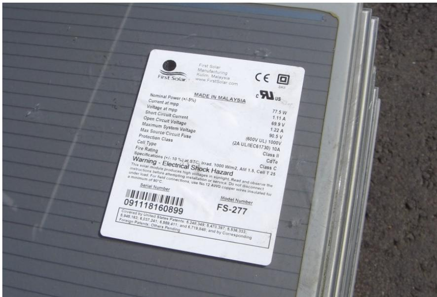
Abbildung 77: Beispiel für Informationen auf dem Etikett eines End-Of-Life Solarmoduls
