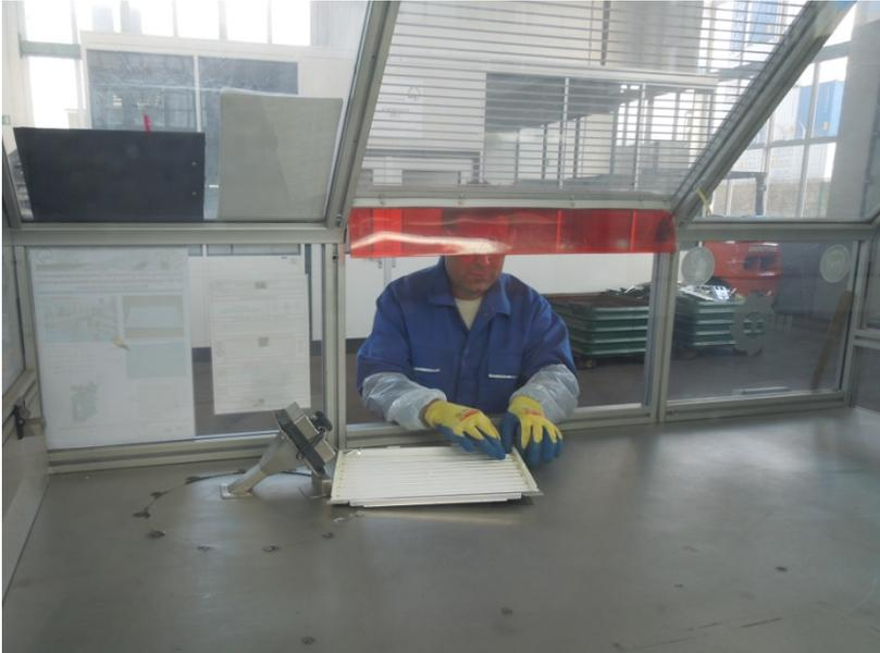
Abbildung 26: geschützte Entnahme von CCFL-Röhren in abgesaugter Sicherheitswerkbank
