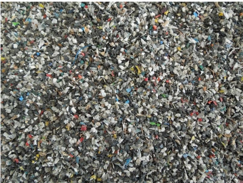
Abbildung 64: Probe der NMRF, zerkleinert auf < 4 mm (Probe A)
