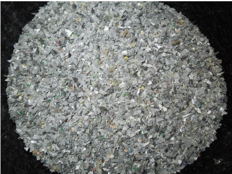
Abbildung 46: Leichtfraktion zerkleinert auf Korngröße  $\leq 4$  mm (Fernseher 1)
