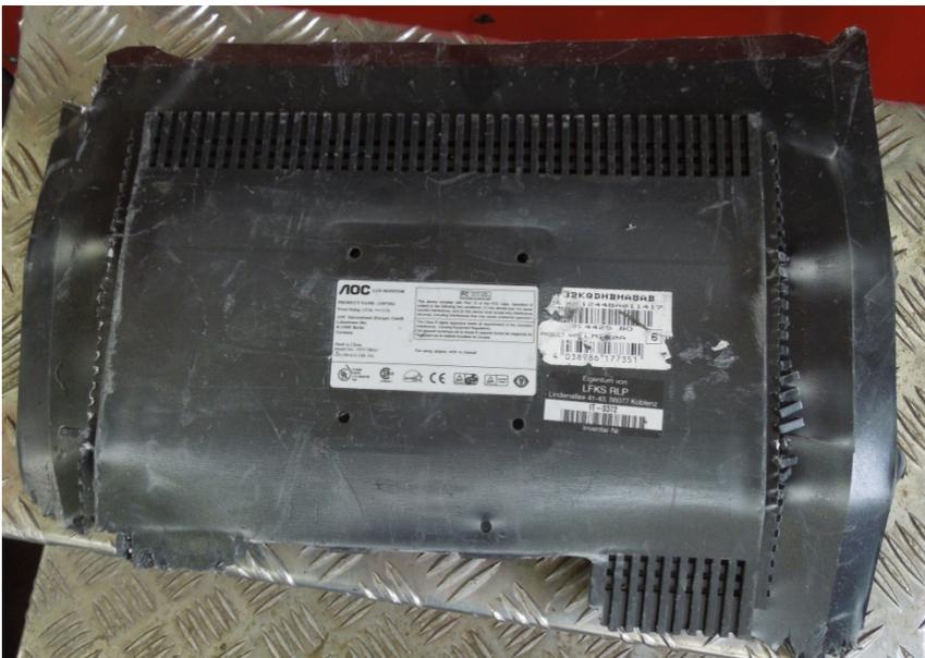
Abbildung 40: vom Einwellenzerkleinerer nicht zerkleinerte Monitorrückwand
