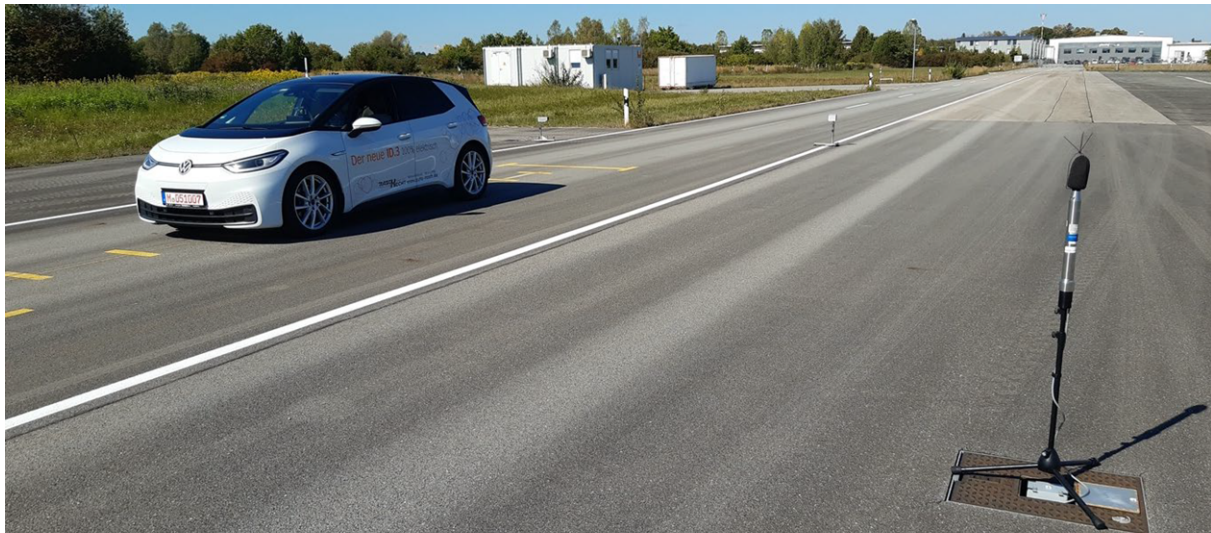
Abbildung 8: Abrollgeräuschmessung auf der Teststrecke
