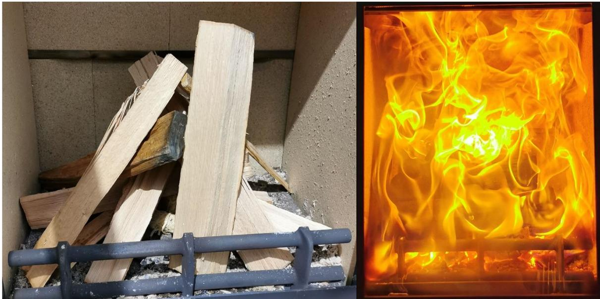
Holz wurde „stehend“ in die Brennkammer gelegt; Ofen wurde überladen; Falsche Lufteinstellung wurde gewählt sodass die gesamte Brennkammer mit Flammen ausgefüllt war (Flammeninferno); Brennstoffauswahl wurde durch die Probanden basierend auf dem verfügbaren Holz selbst durchgeführt
