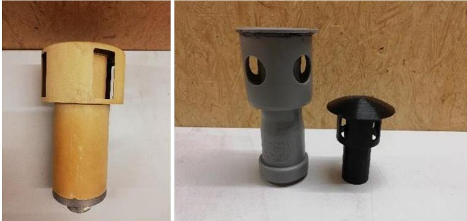
Links Passivsammler Sigma-2; rechts: Prototypen des Probenahmekopfes für PM-LQS
