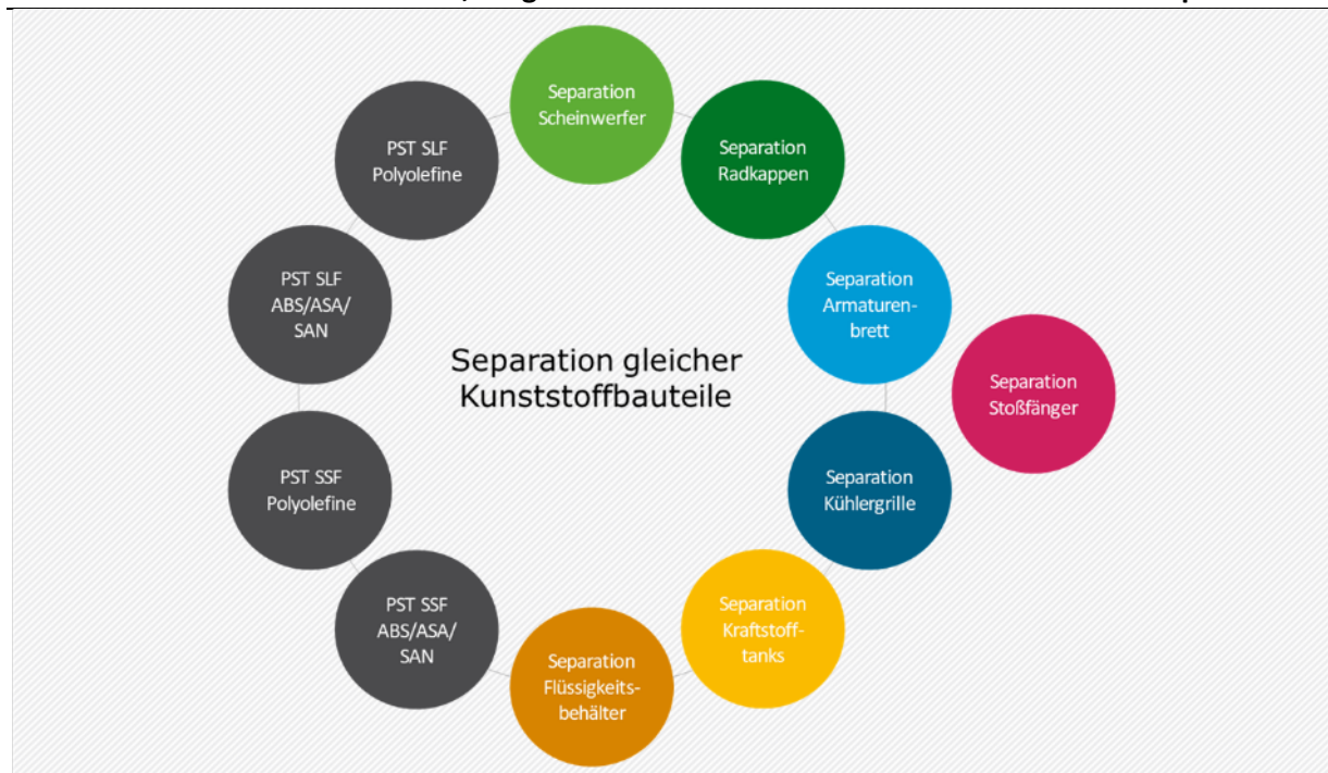
Abbildung 59: Frühzeitige Separation und gemeinsame Aufbereitung von gleicher Kunststoffbauteile, dargestellt anhand der Kombination verschiedener Optionen
