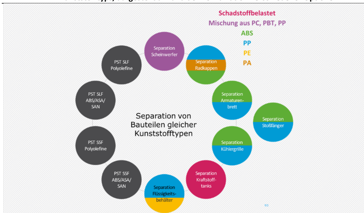
Abbildung 58: Frühzeitige Separation und gemeinsame Aufbereitung von Bauteilen des gleichen Kunststofftyps, dargestellt anhand der Kombination verschiedener Optionen
